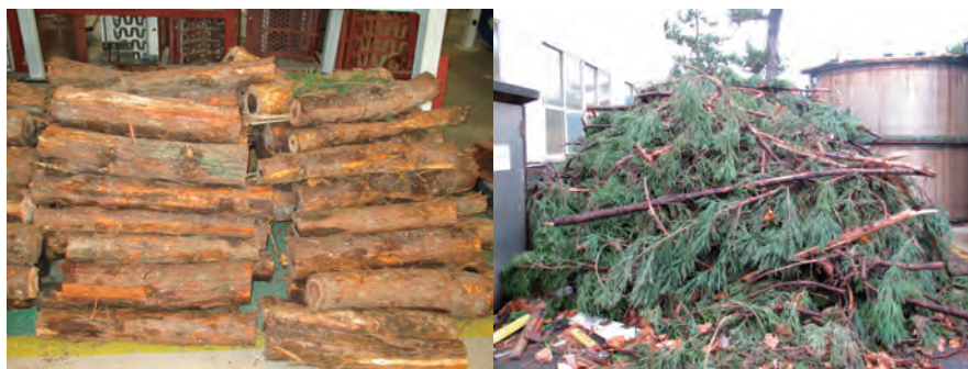
図1 破碎原料の端材(左)と枝条(右)
