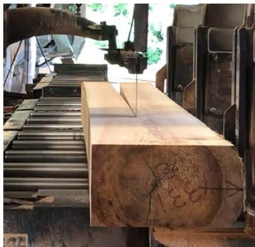
写真1 製材時に発生する心去り平角の反り
