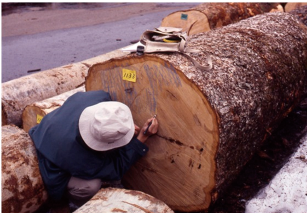
図1 岩手県矢巾町「盛岡木材流通センター」の経営する木材市場に、1995年6月から1998年3月まで2年9カ月の間、毎月市場を訪れ、公売にかけられている芯に空洞や腐りのない健全な丸太の中から大きいものを対象に、伐採面での年輪数と胸高に相当する位置での直径を計測しました。
