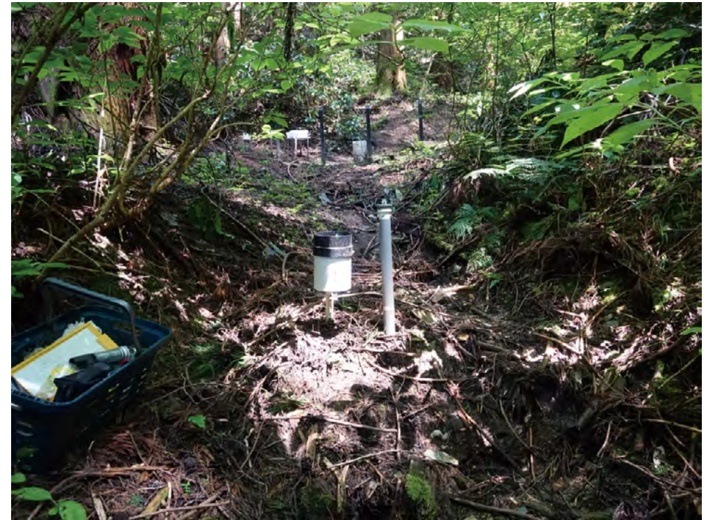
写真1 間隙空気圧測定現場(常陸太田試験地 HA 流域)の様子
