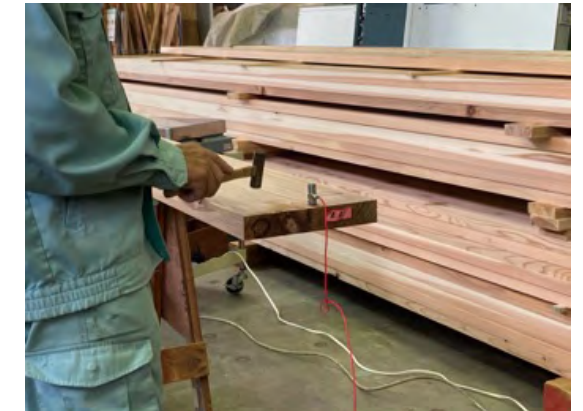
写真1 木口を打撃する方法(左)と広い面の端部を打撃する方法(右)
