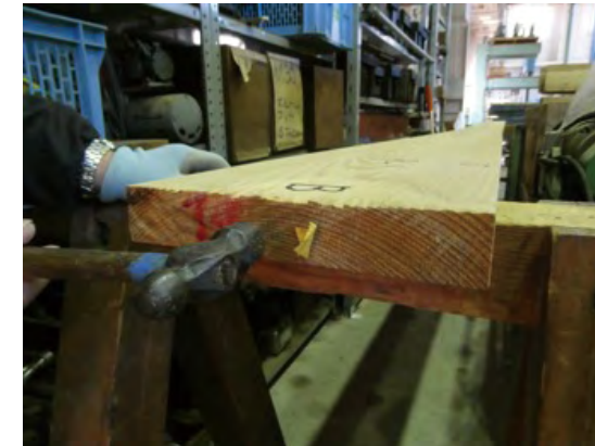
写真1 木口を打撃する方法(左)と広い面の端部を打撃する方法(右)
