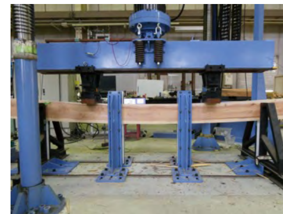
写真2 試験機による曲げ試験の様子
