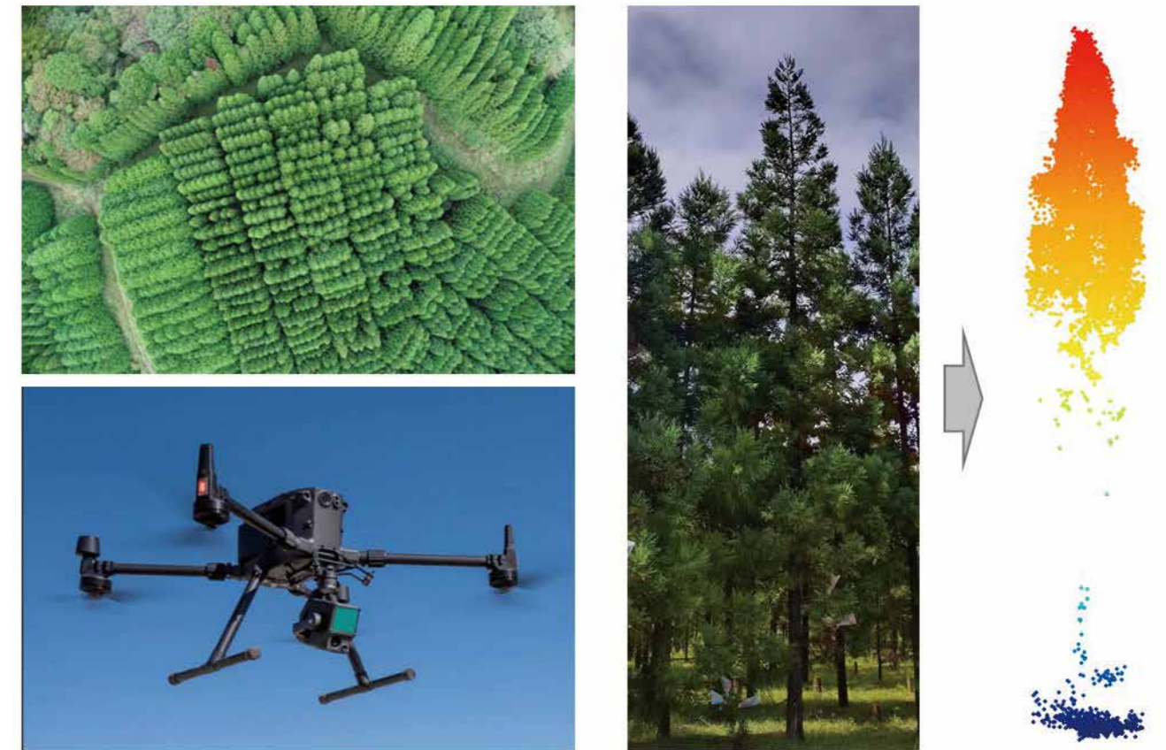
図1 LiDAR搭載ドローンによる樹冠構造のスキャン
