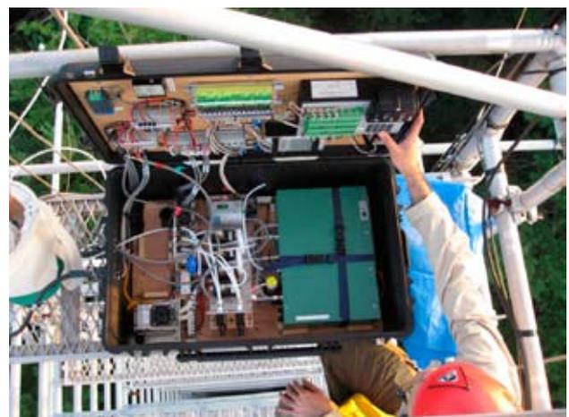
図3 森林総合研究所富士吉田試験地における、ポータブル観測システム(左)を用いた比較観測の様子(右側の測器は経常観測システムの超音波風速計など)
