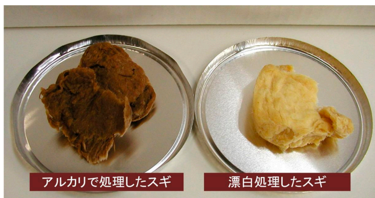
図2 アルカリで処理したスギとそれを漂白処理したもの
