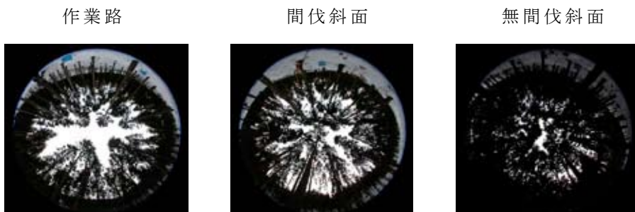
図1 作業路、間伐斜面、無間伐斜面における全天空写真（長坂試験地）
