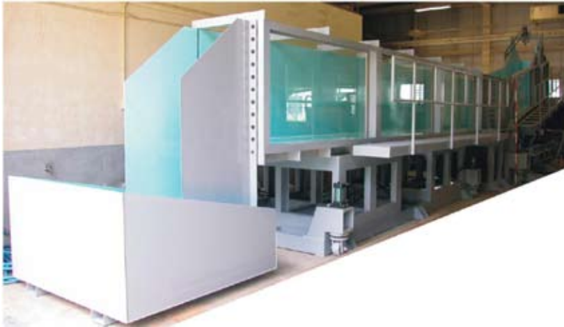
図1 土石流実験に用いた大型の人工水路の全景 全長 13m (水平部長さ 8m、勾配可変部長さ 5m)、幅 0.6m
