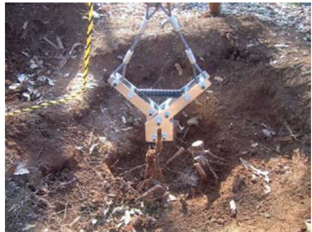
写真2 根の引き抜き試験
