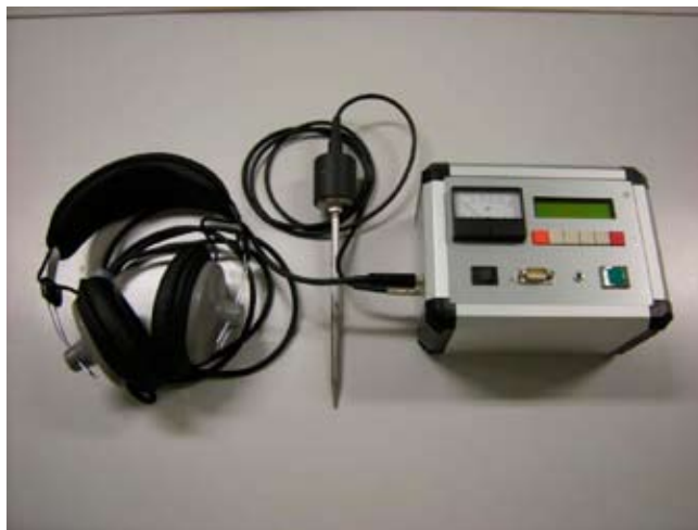
写真2 普及型地下流水音探査装置
