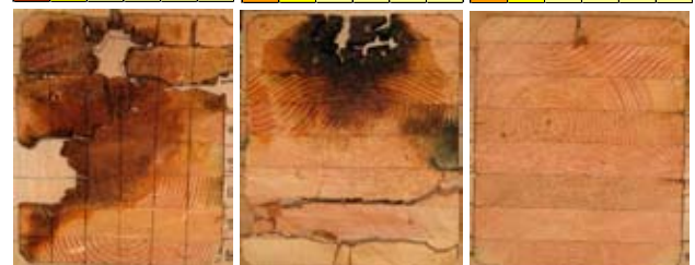
写真6 部材の断面内含水率分布と切断面 左から最初の破壊箇所、最終破壊箇所、健全部材
