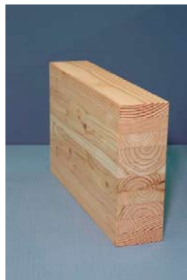
写真1 異樹種集成材の例 (外層：ベイマツ、内層：スギ)
