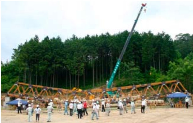
写真2 土嚢積載により破壊した木橋
