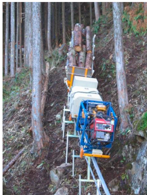
写真2 運搬台車による端材の運搬
