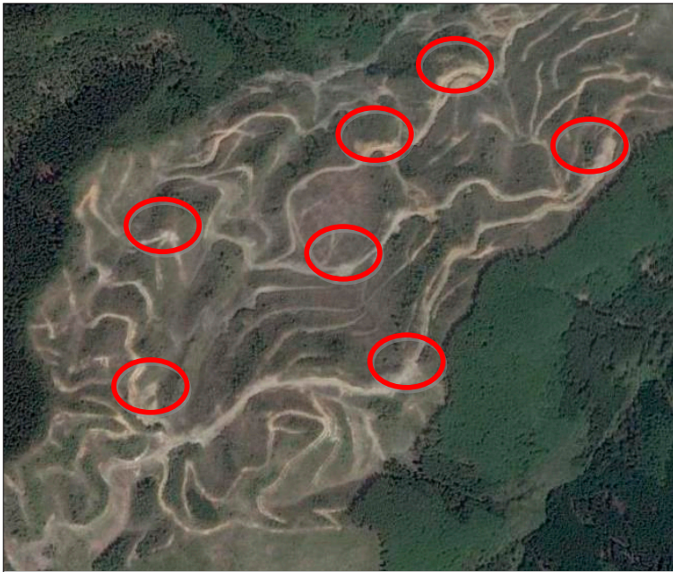
図1 皆伐後5年が経過した大規模皆伐地の状況 (赤く囲った場所では現在でも作業道の崩壊が見られる)
