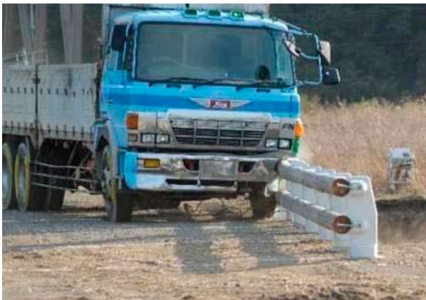
写真3 10年経過木製防護柵の大型貨物車による実車 衝突確認試験（衝撃度 54.6kJ） （劣化度が1～2程度ならば十分な衝突抵抗性能を維持）
