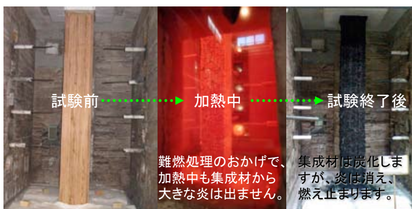
写真1 耐火集成材柱の耐火加熱試験
