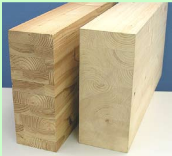
幅はぎラミナ集成材 (左) と 台形ラミナ集成材 (右)
