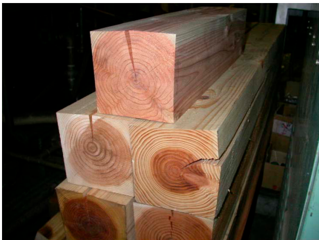
写真1 心持ち材（スギ）の天然乾燥における表面割れ
