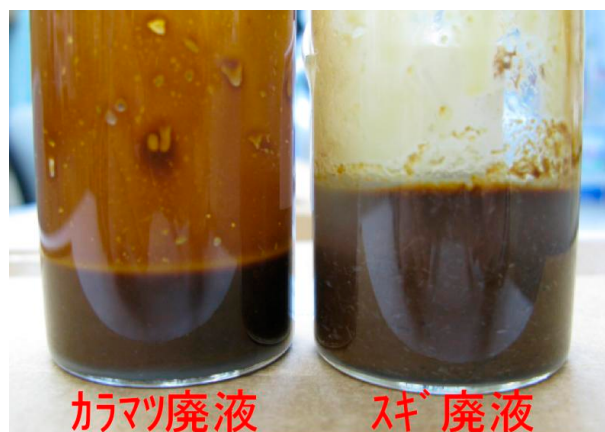
写真2 針葉樹材の乾燥で得られた粘着性物質
