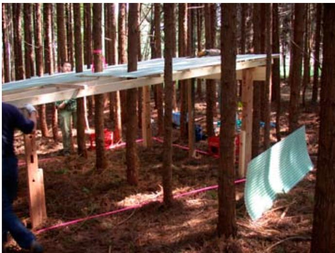
図3. 降雨遮断処理の様子. 広さ3.5 m × 3.5 m、高さ1.2 m ~ 1.7 mの雨よけ屋根をスギ林内に設置し、4月~9月の6ヶ月間にわたり雨を遮断して土壌を乾燥させた。1つの屋根が3本のスギの下の地表を覆っている。
