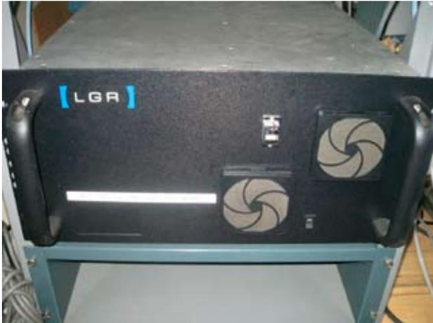
図-1 波長可変ダイオードレーザー分光法 (TDLS) メタン計
