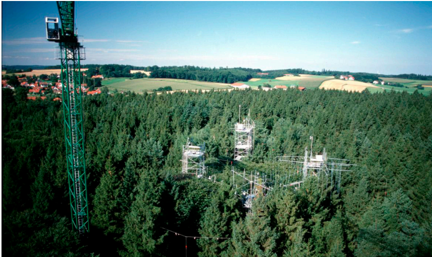
写真1 ヨーロッパブナ成木への オゾン暴露試験 タワーにより樹高約30メートル のヨーロッパブナ成木へのオゾン 処理と樹冠内の葉の測定が可能と なっている。
