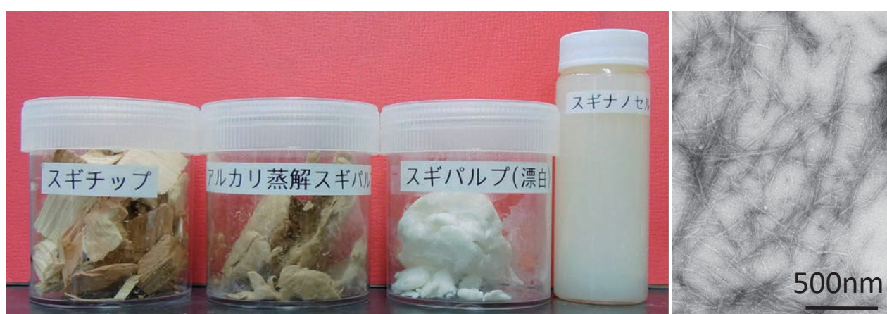
図3 スギのチップ、パルプ、漂白パルプおよびセルロースナノファイバー懸濁液（1%）とセルロースナノファイバーの透過電子顕微鏡写真
