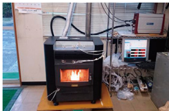
図3 ペレットストーブ燃焼試験
