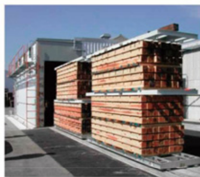
図3 蒸気・高周波複合乾燥装置
