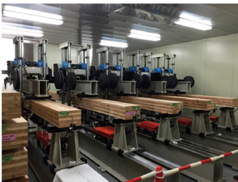
図4 長期間曲げ荷重を加える CLT の強度性能試験
