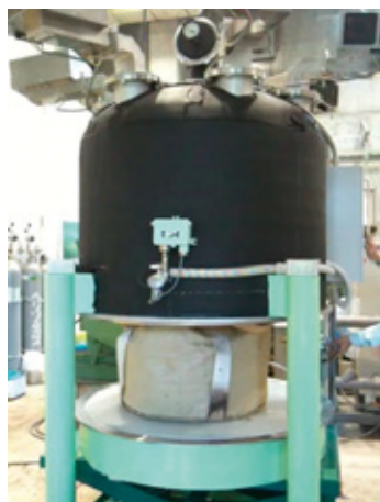
図3 新しく開発したマイクロ波減圧コントロール抽出装置
