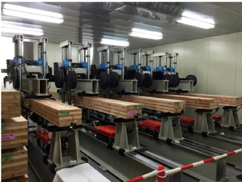
図4 長期間曲げ荷重を加える CLT の強度性能試験
