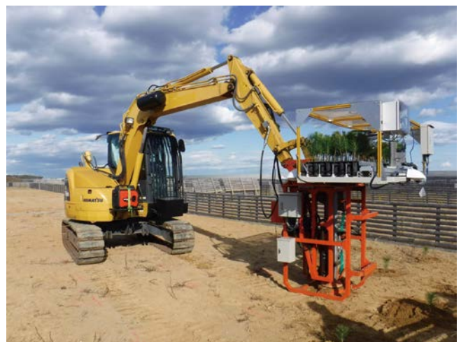
コンテナ苗の自動植栽機を開発しました。
