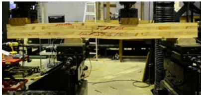
上図：床利用を想定したせん断試験、 右図：壁利用を想定したせん断試験
