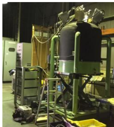
図2 減圧式マイクロ波抽出装置
