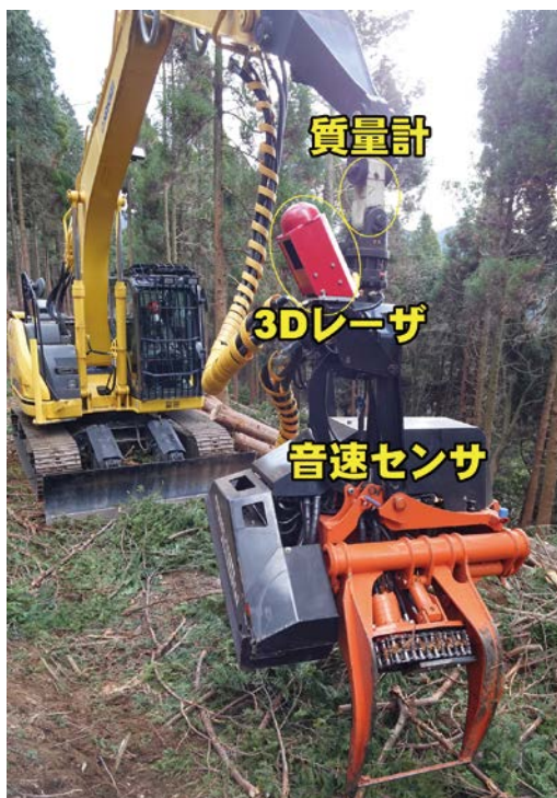
図1 開発したハーベスタ 情報共有の機能を運転席の制御機器に搭載
