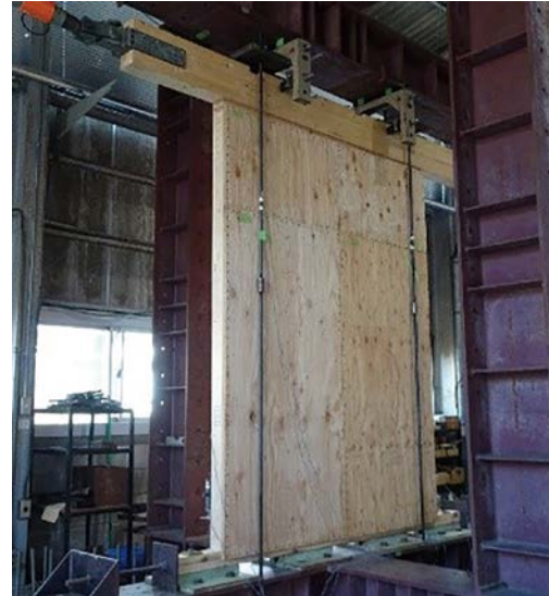
図2 壁の面内せん断試験
