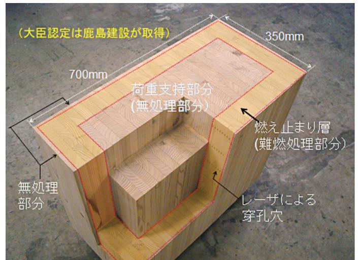
図1 大臣認定仕様の1時間耐火構造集成材 (柱・梁)
