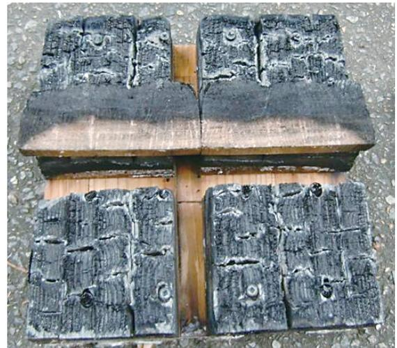
図4 キット同士は単純に突き合わせるだけでも内部まで燃えこみません。
