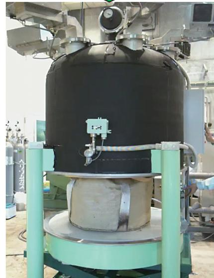
図5 減圧式マイクロ波水蒸気蒸留装置(実用規模)
