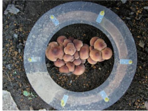
図2 ナメクジ忌避試験 環状合板断面
