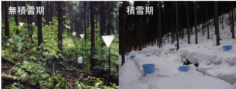
図9 無積雪期および積雪期の樹冠通過降水量観測
