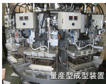
水分と熱による可塑性、成型
