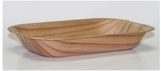
図5 深形木製単層トレイ(曲げ角度60°、深さ30mm)
