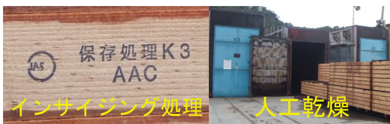
図2 製材品の様々な加工条件の例 （左：インサイジング処理） 保存薬剤が木材に入りやすいように、刃物等で表面を処理すること。 （右：人工乾燥の様子） 蒸気や電気等を用いて木材を人工的に乾燥すること。
