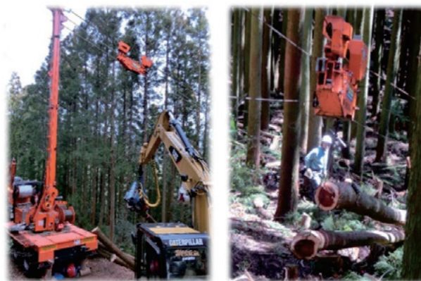
図1 タワーヤーダによる集材作業 ワイヤーロープ上を走行する搬器 が木材を運搬します。
