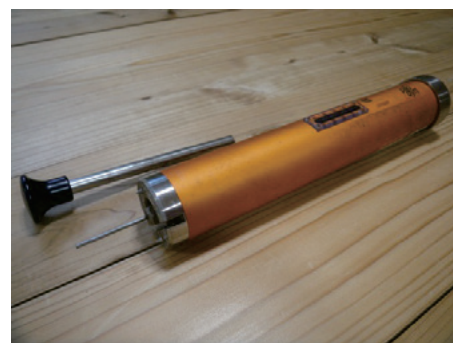
図1 ピロディン: 直径2.5mmの金属棒をバネにより一定のエネルギーで木材に打ち込み、その貫入深を測定する機器。
