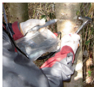
図3 横打撃共振法で共振周波数を測定している様子
