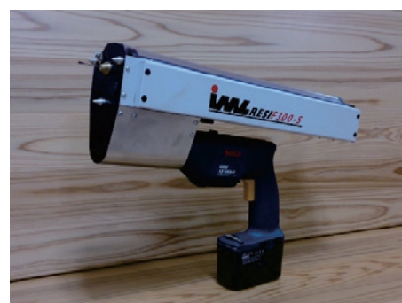
図2 レジストグラフ: 先端が三味線のバチ状になった針(幅3.0mm)を、回転させながら木材に穿孔していく際の抵抗値変化を記録する機器。
