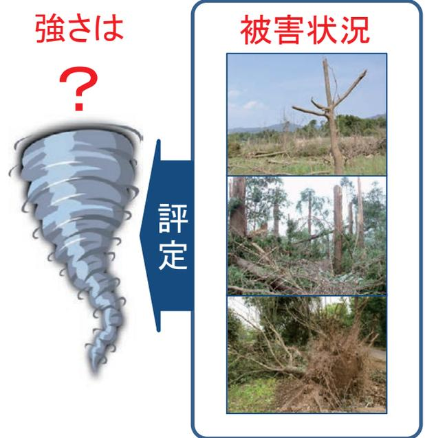
図1 竜巻等突風強さの評価の概念と樹木の被害形態(上:枝折れ、中:幹折れ、下:根返り)
