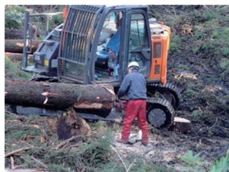
図3 プロセッサの処理可能径を超えた大径木処理の様子
