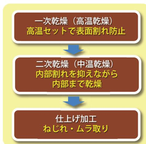
図2 コアドライ材の生産工程。なお、1次と2次乾燥の間に、養生工程を設ける場合もあります。
