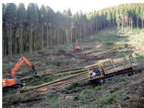
図1 高性能林業機械の作業システムによる高齢級人工林の主伐状況
