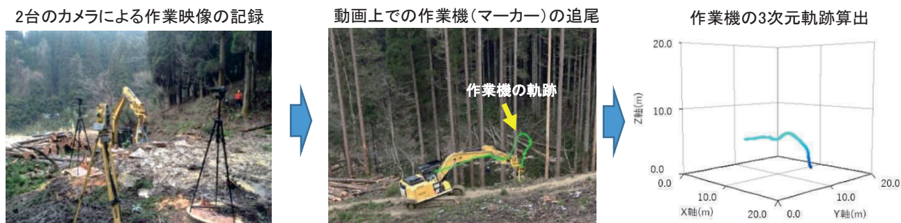
図3 機械および伐倒木の動作計測による外力の推定
