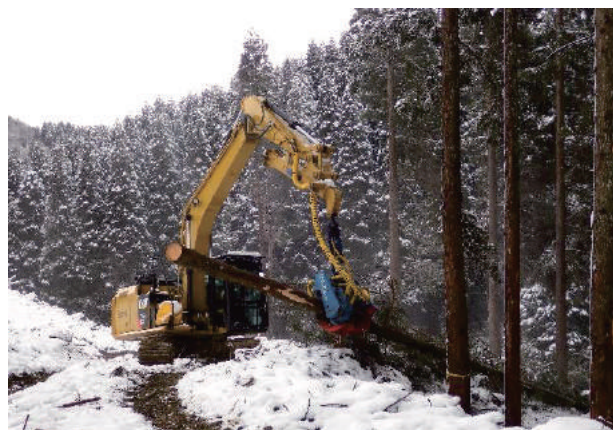
図1 ハーベスタを使用した造材作業の様子 胸高直径が50cmを超えると木の質量は3トン以上になります。
