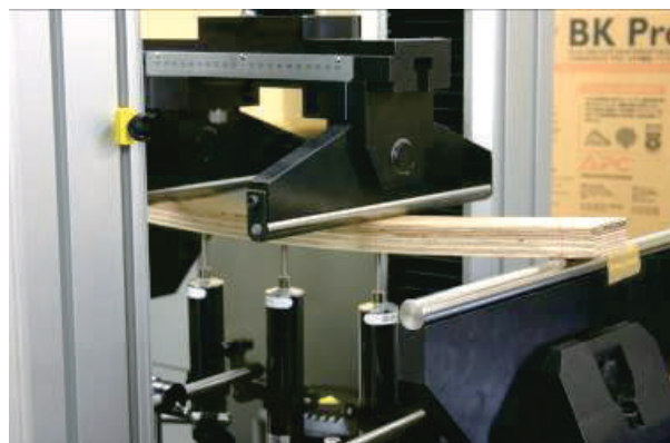
写真1 曲げ性能の試験の様子
