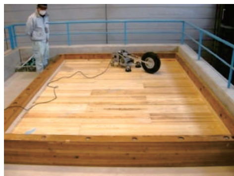
図8 重量衝撃音試験の様子
