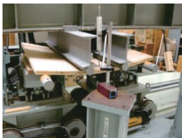
図6 パネルの曲げ試験
