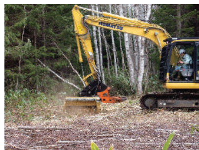
写真3 新たに導入した地拵え機械クラッシャ
