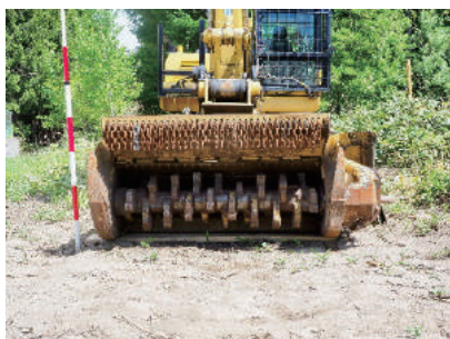
写真3 新たに導入した地拵え機械クラッシャ
