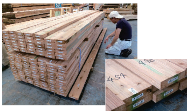
図3 試作CLT用のラミナ
