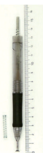
図5 定力打撃装置
