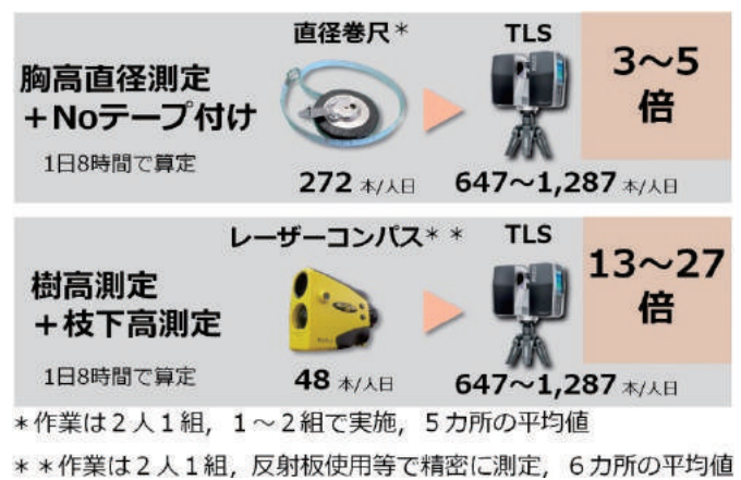
図7 TLSと従来の調査方法の作業効率
