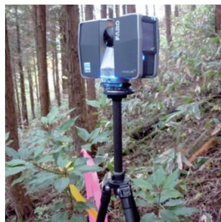
図2 地上型三次元レーザースキャナ （米FARO社製 Focus3D）
