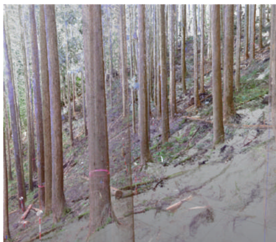
図3 TLSで得られた点群データ RGBデータを重ねているのでカラー写真 のように見える。
