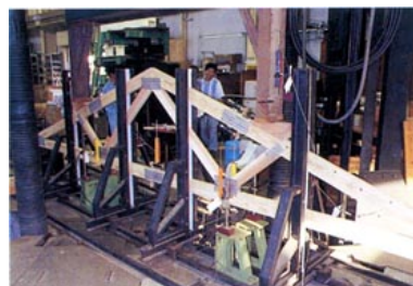
写真2. トラスの実大曲げ試験
