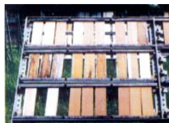
写真6. 野外暴露試験
