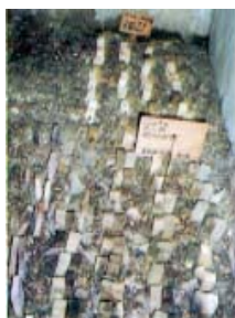
写真4. ファンガスセラー（室内促進腐朽試験）
