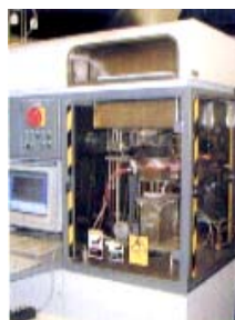
写真5. コーンカロリーメーター（ISO準拠燃焼試験装置）
