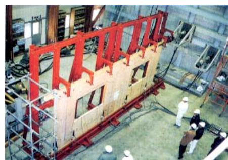
写真. 実大サイズ（長さ7.2m）の耐力壁の耐震試験
