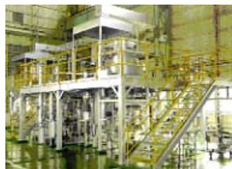
写真：ガス化メタノール合成装置
