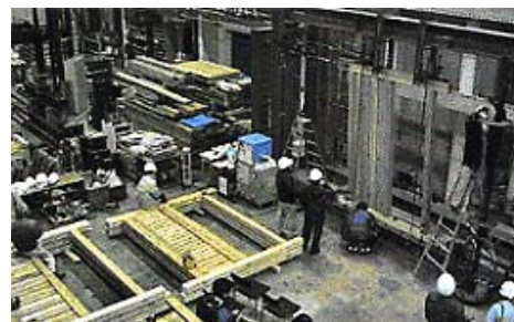
スギを多用する板倉構法用壁の実大実験
