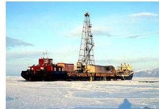
写真1 バイカル湖の湖底堆積物を採取するための掘削船
