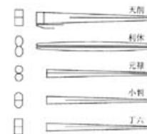
図1. 割り箸の種類とその平面図及び中央の断面図
