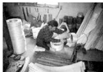
写真2. 薄く剥いだ木材を曲げているところと、曲げたせいろの材料を乾かしているところ
