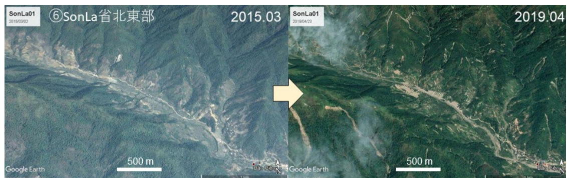
図 4-2-2-9 ソンラ省北東部⑥の崩壊発生前後の衛星画像
