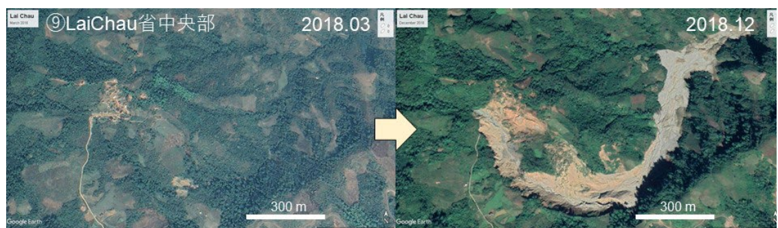
図 4-2-2-12 ライチャウ省中央部⑨の崩壊発生前後の衛星画像
