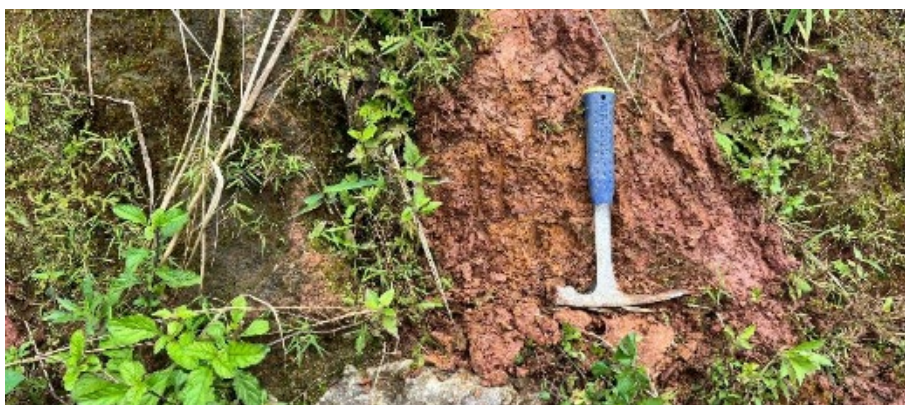
図 4-2-2-10 石灰岩層中にパッチ状に分布する粘土化した強風化層
