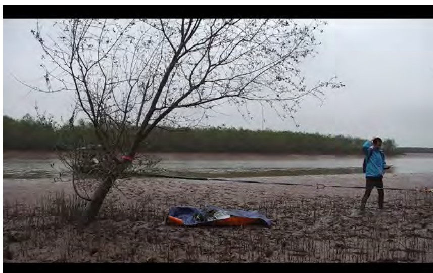
図 4-4-5-3 XTNP の Sonneratia caseolaris を対象とした引き倒し試験風景
