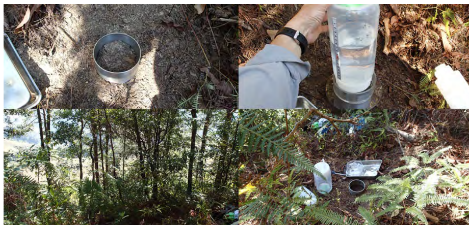
図 4-2-2-10 林地における現地浸透能試験の様子(2022 年 12 月)
