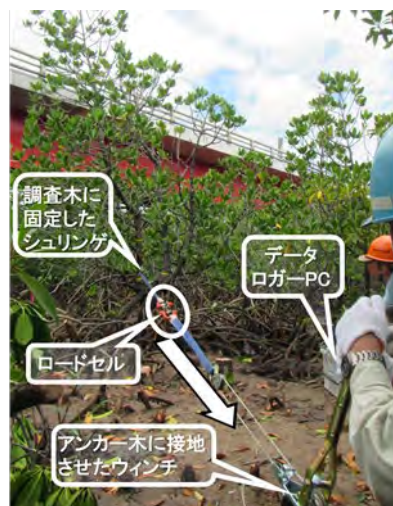
図 4-4-5-1 ヤエヤマヒルギ林における引き倒し試験予備調査
