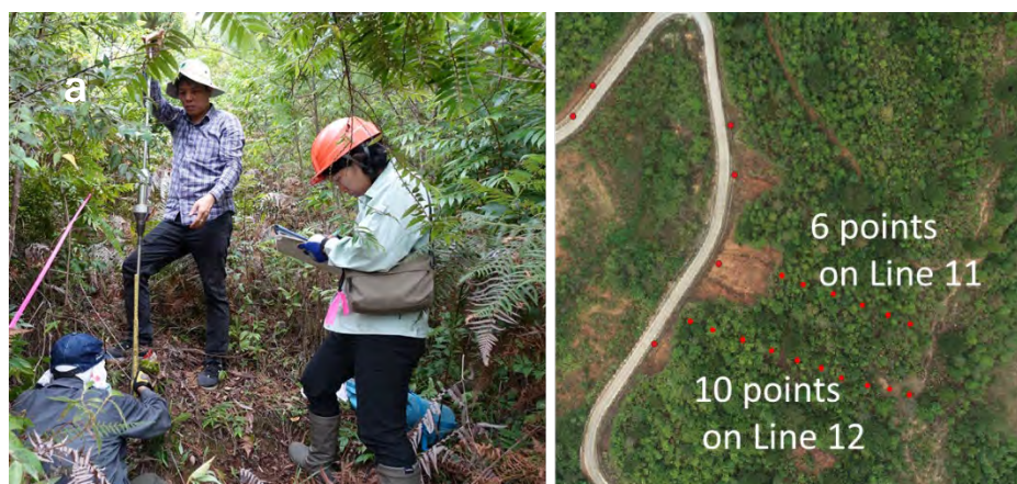
図 4-2-2-10a 簡易貫入試験の様子と実施位置
