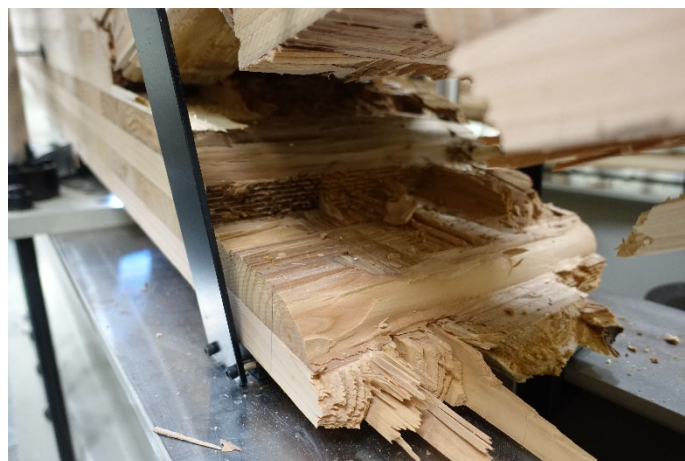
写真 7-3-12 DOL-92-1 フィンガージョイント部破断②
