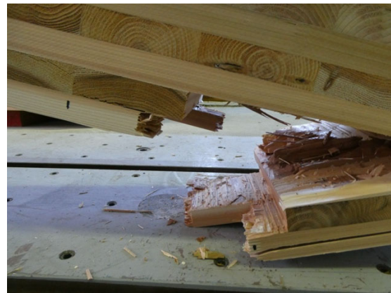
写真 4-1-10～11 破壊形態の例 (Mx60-9-9_2)
