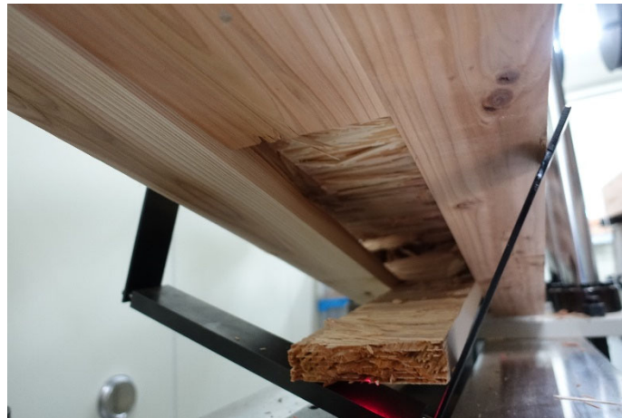
写真 7-3-5 DOL-88-1 梁下端フィンガージョイント部破断①
