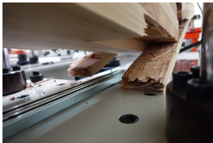
写真 7-3-6 DOL-88-1 梁下端フィンガージョイント部破断②
