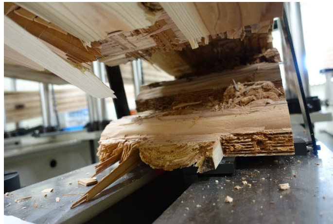
写真 7-3-11 DOL-92-1 梁下端フィンガージョイント部破断①
