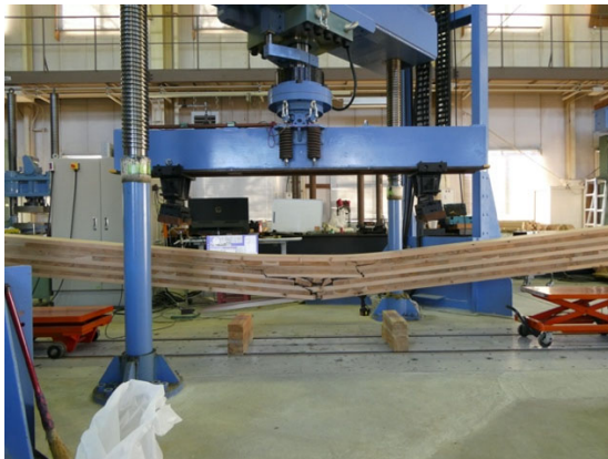
写真 4-1-12～13 破壊形態の例 (Mx60-9-9_7)
