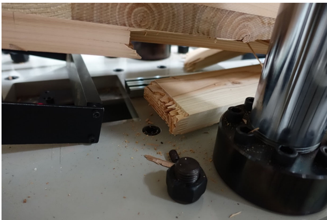
写真 4-3-3 DOL-94-1 梁下端フィンガージョイント部分の破断①
