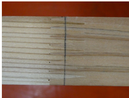
写真 4-1-1 FJ の形状 (写真下部の FJ が垂直になっている部分がバット部)
