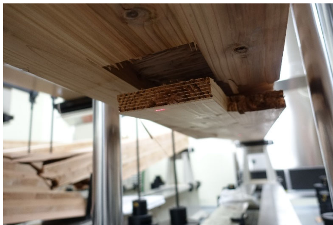
写真 7-3-3 DOL-86-1 梁下端フィンガージョイント部破断②
