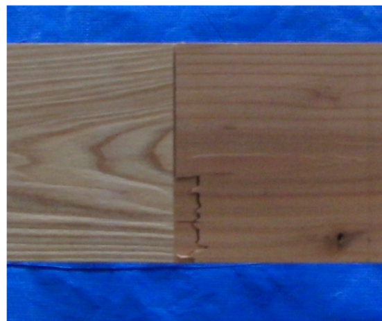
写真 4-1-4～5 M60B の破壊形態の例 (M60B-1)
