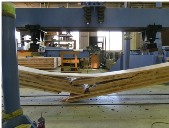
写真 4-1-10～11 破壊形態の例 (Mx60-9-9_2)
