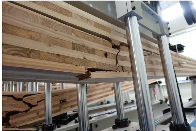
写真 7-3-7 DOL-90-1 破壊状況
