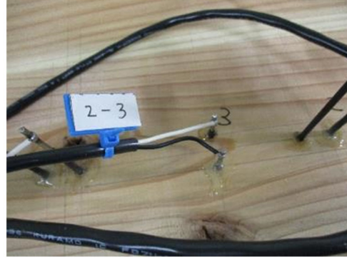
図 3-3-19 プローブの固定状況 (エポキシ接着剤充填)
