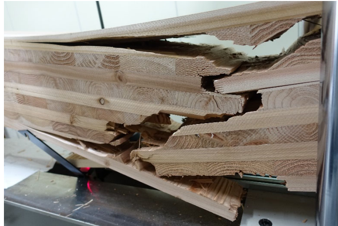
写真 7-3-4 DOL-88-1 破壊状況
