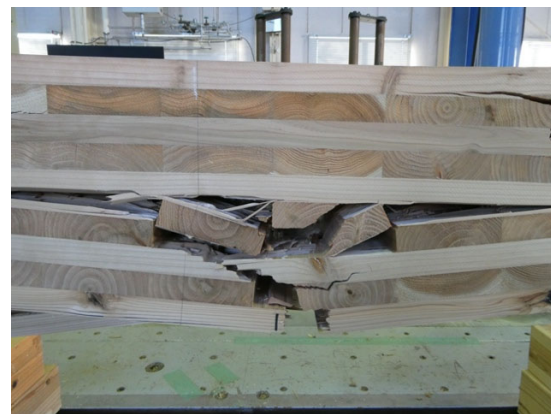
写真 4-1-12～13 破壊形態の例 (Mx60-9-9_7)
