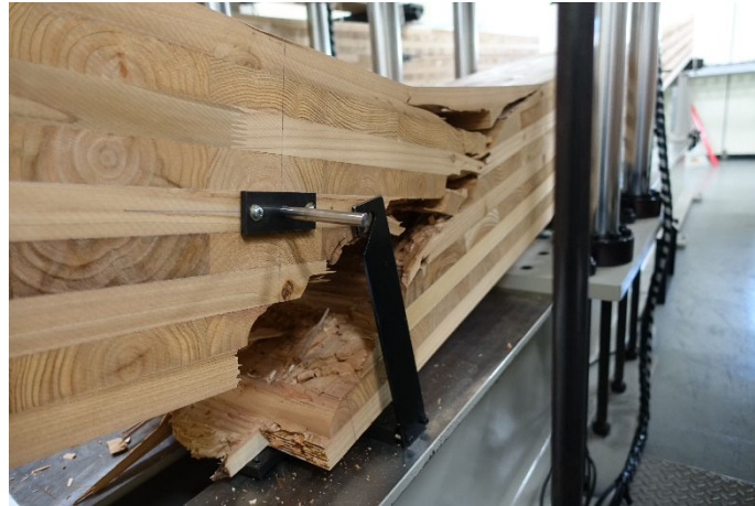
写真 7-3-10 DOL-92-1 破壊状況
