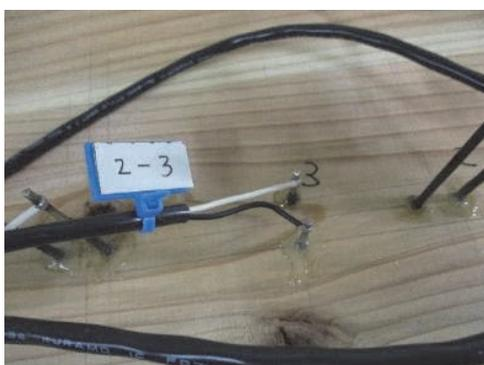
図3-21 プローブの固定状況
