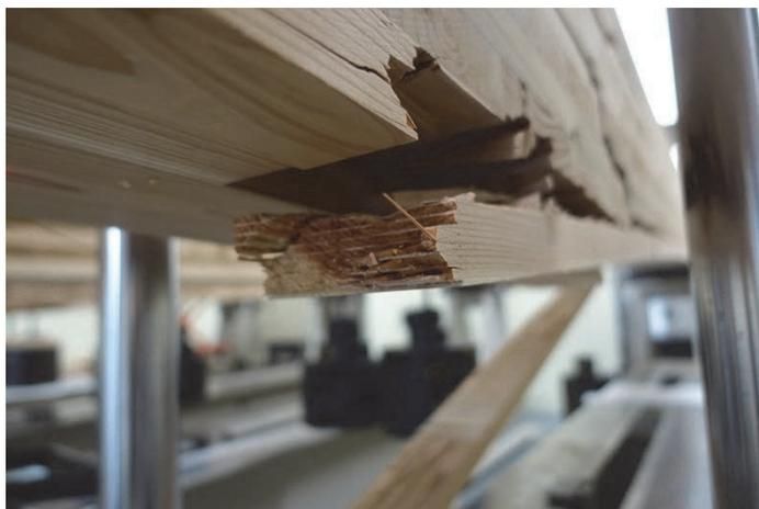
写真 7-3 DOL-84-2 引張側フィンガージョイント部破断②
