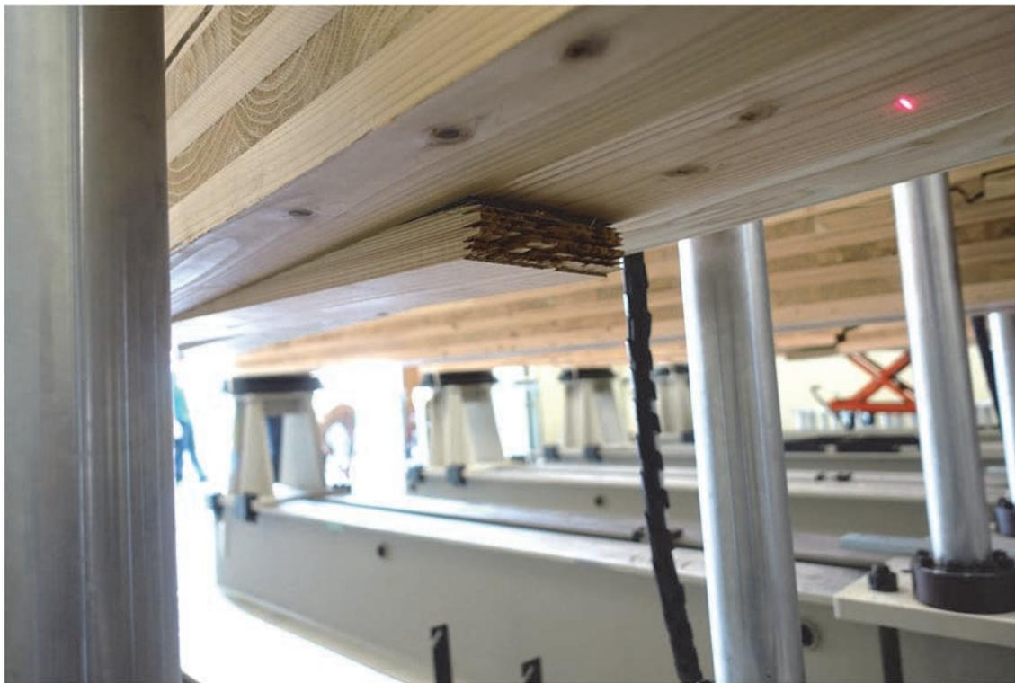
写真 4-3-4 DOL-84-1 引張側フィンガージョイント部分の破断
