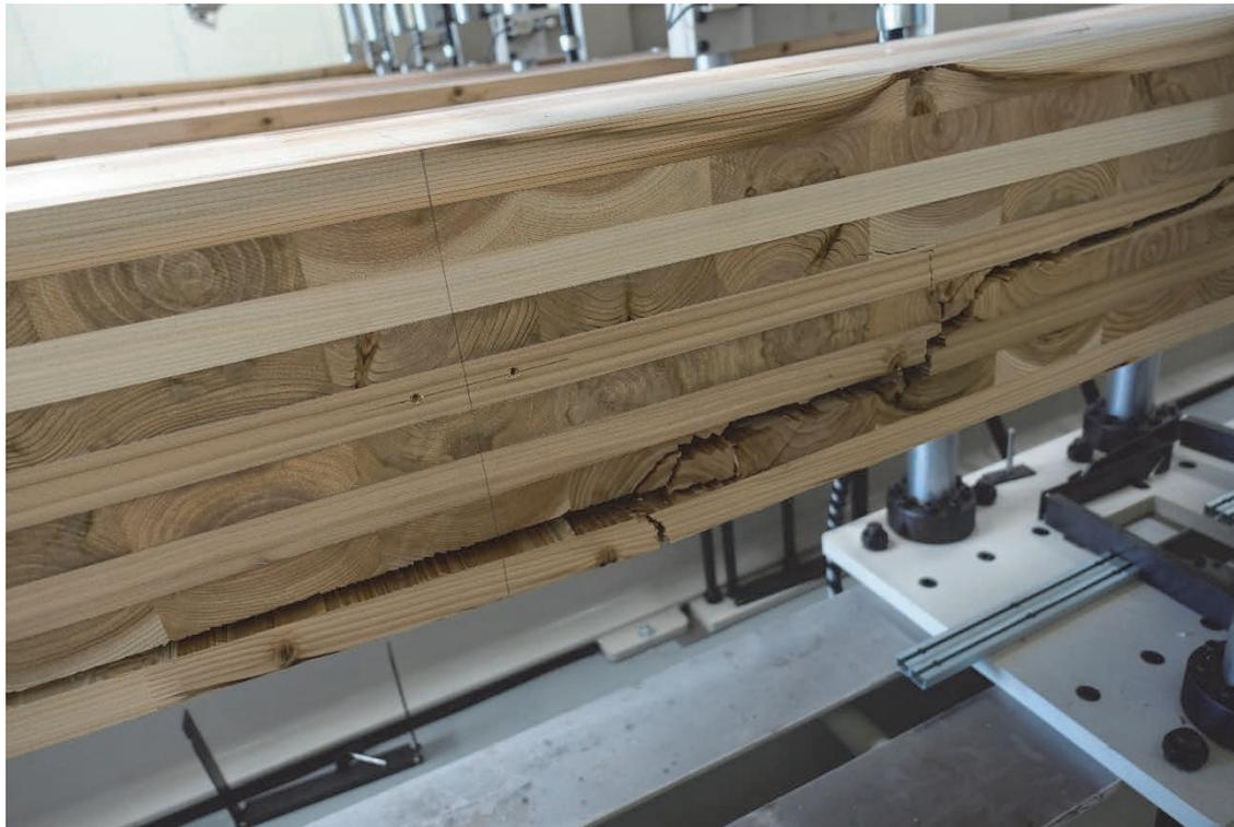
写真 4-3-3 DOL-84-1 破断状況②
