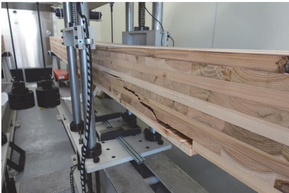
写真 4-3-2 DOL-84-1 破断状況①
