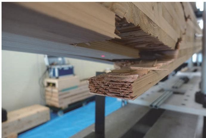
写真 7-12 DOL-80-1 引張側フィンガージョイント部破断
