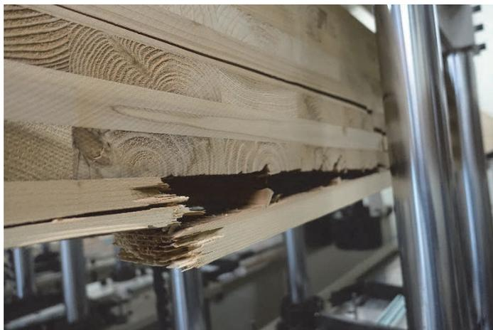
写真 7-27 D0L-76-2 フィンガージョイント部破断
