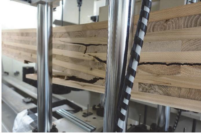
写真 7-7 DOL-82-2 破壊状況①
