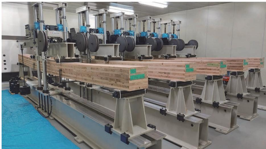
図 4-2-1 曲げクリープ破壊試験の様子
