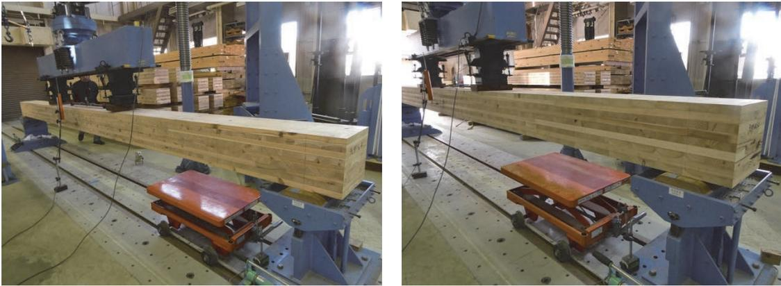
写真 2-2-2~3 曲げ試験の様子(左：強軸試験体、右：弱軸試験体)
