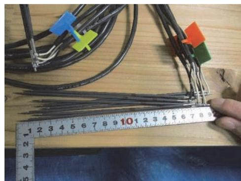
図3-20 測定プローブへのリード線の接続
