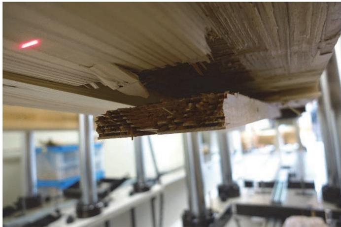
写真 7-2 DOL-84-2 引張側フィンガージョイント部破断①
