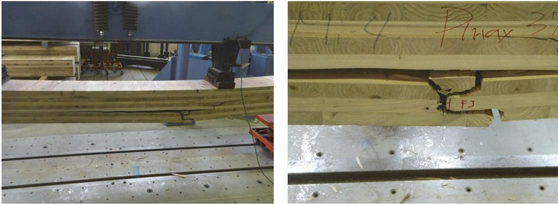
写真 2-2-6~7 9L9P-Mi の破壊形態の例
