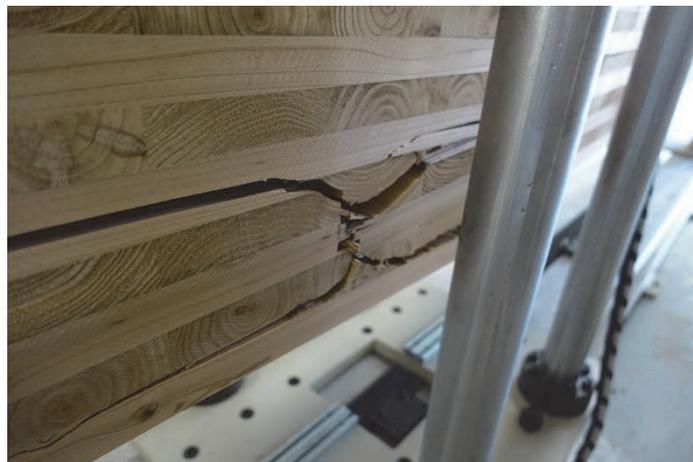
写真 7-23 DOL-76-1 破壊状況②
