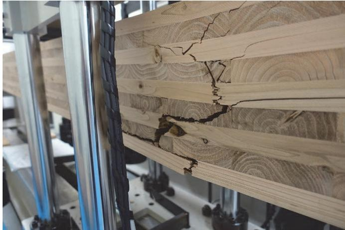
写真 7-13 DOL-80-2 破壊状況①
