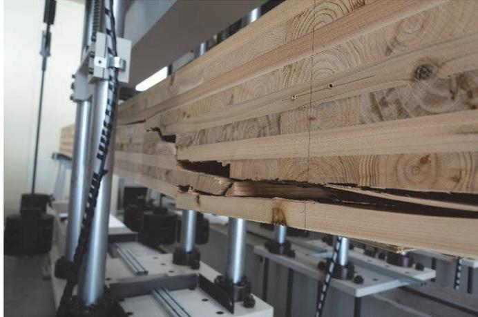
写真 7-4 DOL-82-1 破壊状況
