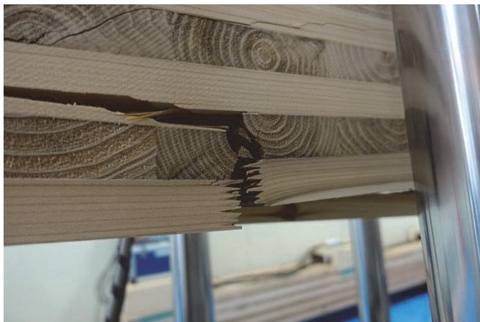
写真 7-15 DOL-80-2 引張側フィンガージョイント部破断
