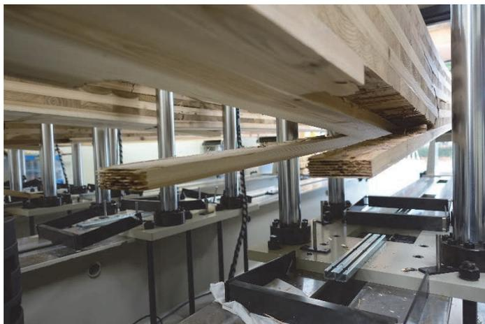
写真 7-9 DOL-82-2 引張側フィンガージョイント部破断
