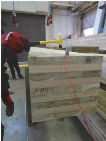
写真 2-2-1 動的たわみ振動測定の様子
