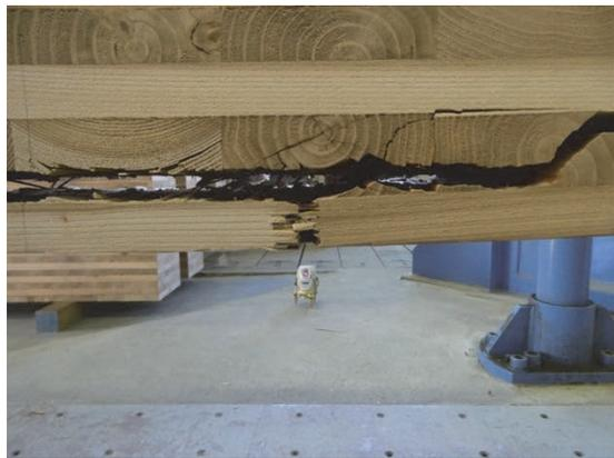
写真 2-2-4~5 9L9P-Ma の破壊形態の例
