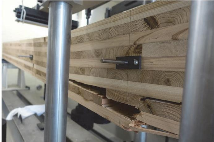
写真 7-16 DOL-78-1 破壊状況①
