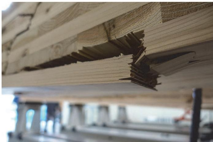
写真 7-21 DOL-78-2 フィンガージョイント部破断
