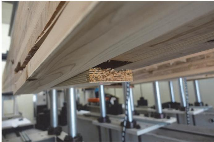
写真 7-5 DOL-82-1 引張側フィンガージョイント部破断①
