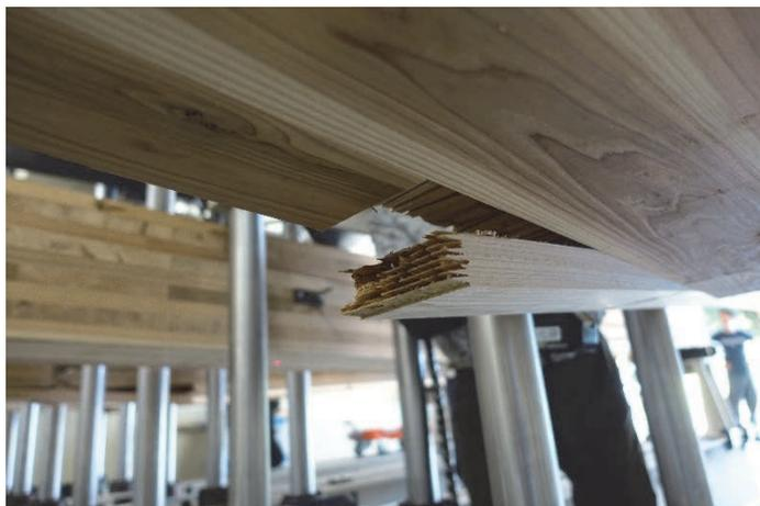
写真 7-18 DOL-78-1 フィンガージョイント部破断
