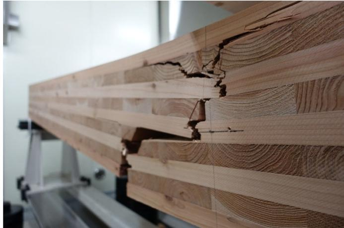
写真 7-13 DOL-86-2 破壊状況①
