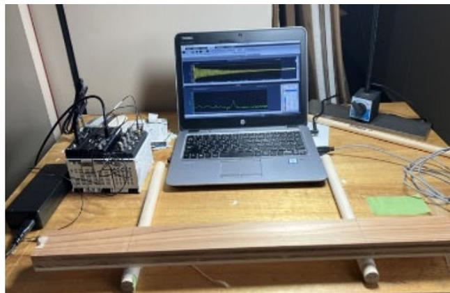
図 3-9-4 たわみ振動法測定状況
