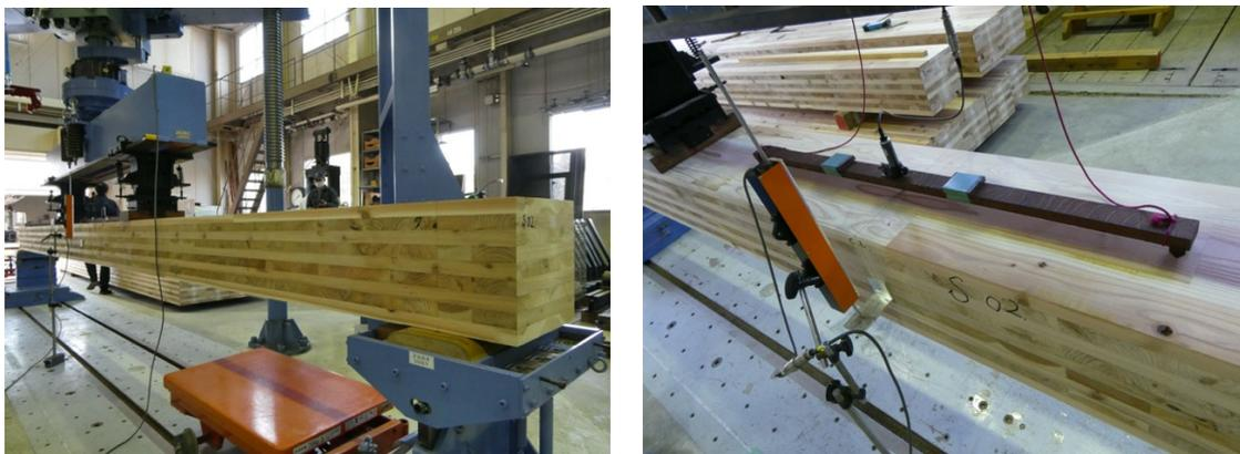
写真 4-1-1~2 CLT の短期曲げ試験の様子
