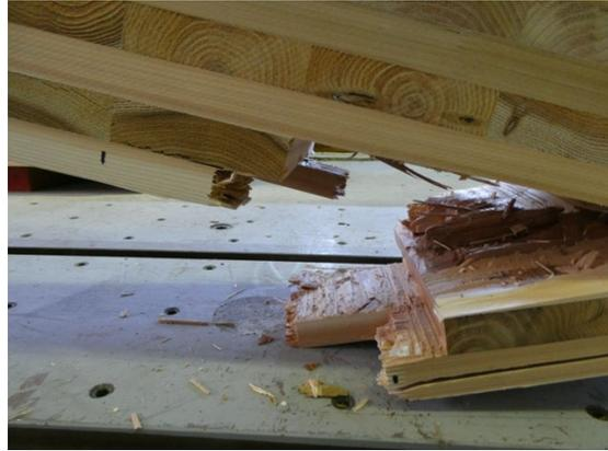
写真 4-1-3~4 破壊形態の例 (Mx60-9-9\_2)
