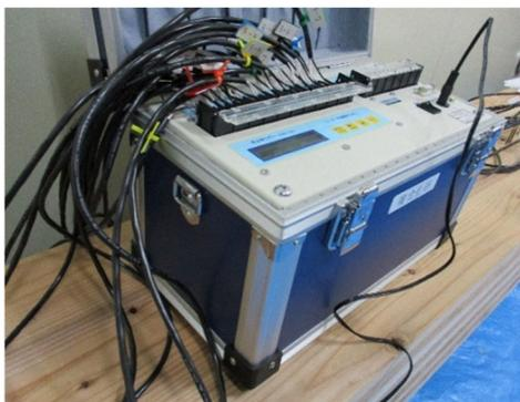
図3-4-9 使用した含水率記録計(コーナー札幌:KNS-LOG)
