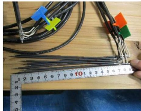
図 3-4-2 測定プローブへのリード線の接続
