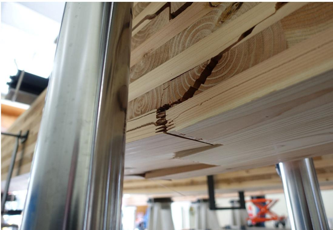
写真 4-3-4 D0L-66-1 引張側フィンガージョイント部分の破断
