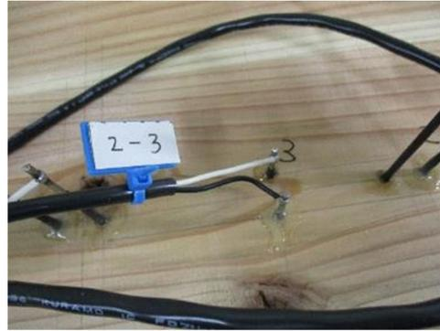
図3-4-6 プローブの固定状況(エポキシ接着剤充填)
