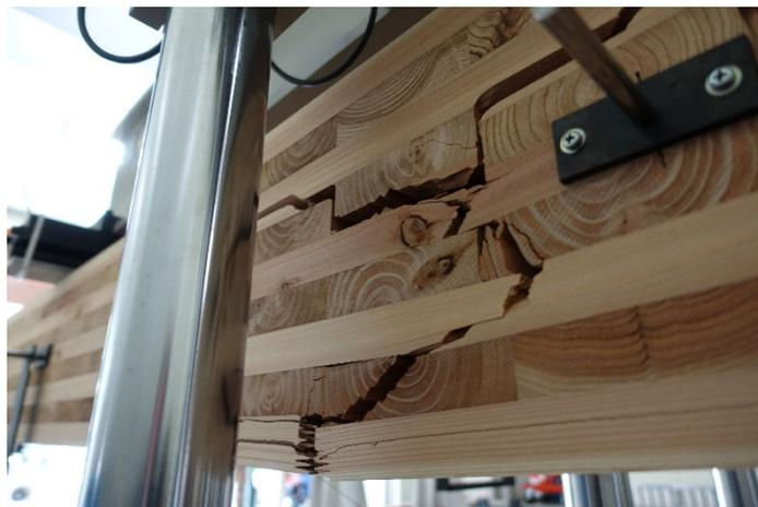
写真 7-30 DOL-66-1 引張側フィンガージョイント部破断
