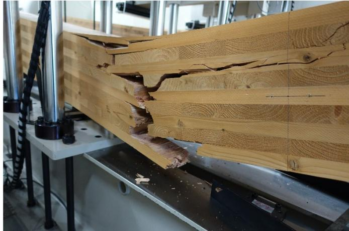
写真 7-7 DOL-90-2 破壊状況①
