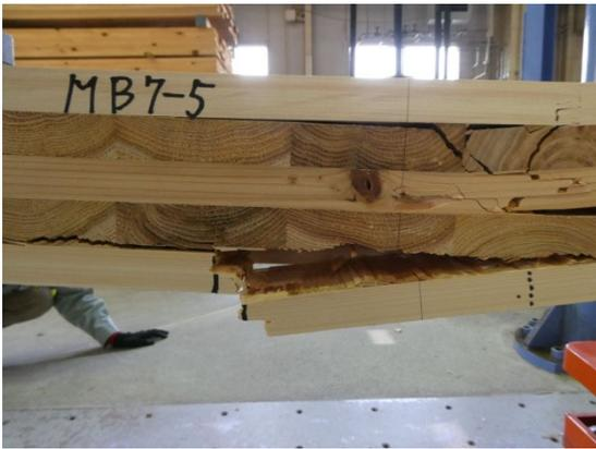
図 2-2-13 MB7 5L5P スギ M120B-スギ M60B
