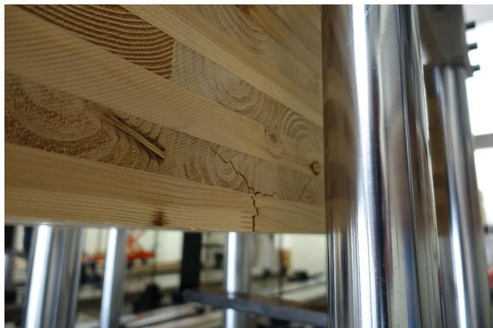
写真 7-21 DOL-72-1 フィンガージョイント部破断
