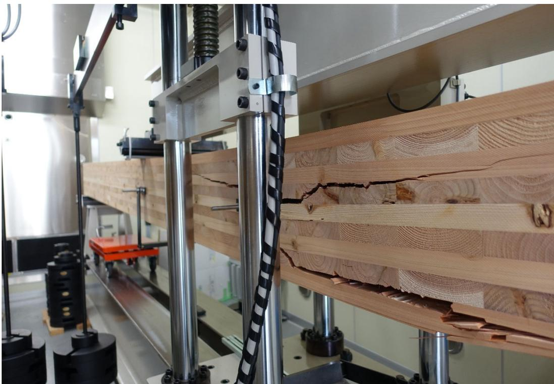
写真 4-3-2 DOL-66-1 破断状況①
