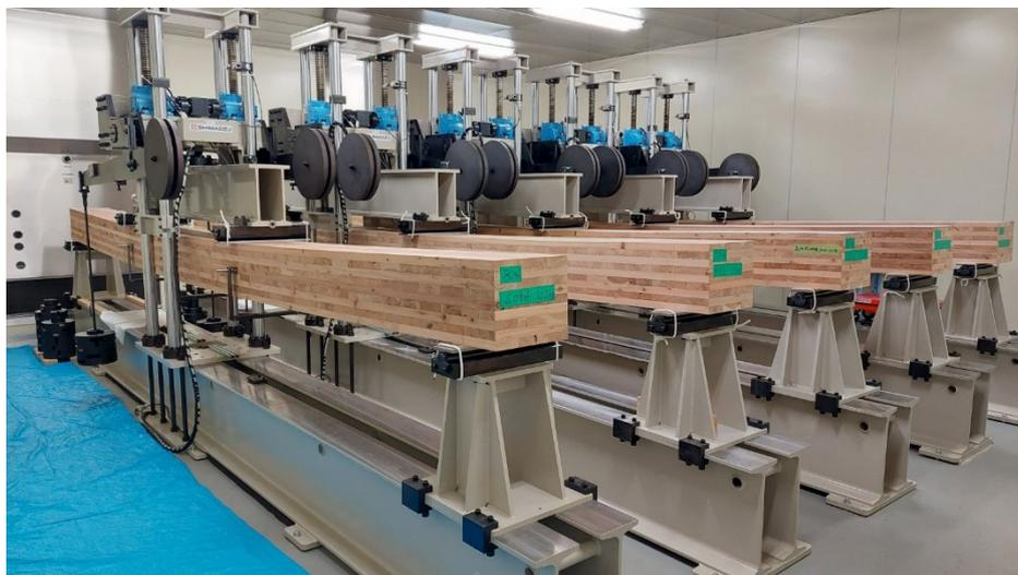
図 4-2-1 曲げクリープ破壊試験の様子
