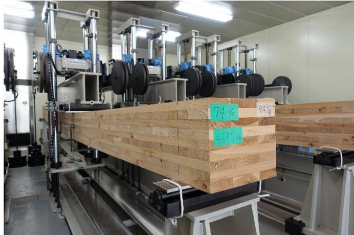
写真 7-16 DOL-74-1 全体状況 (破壊に至らず)
