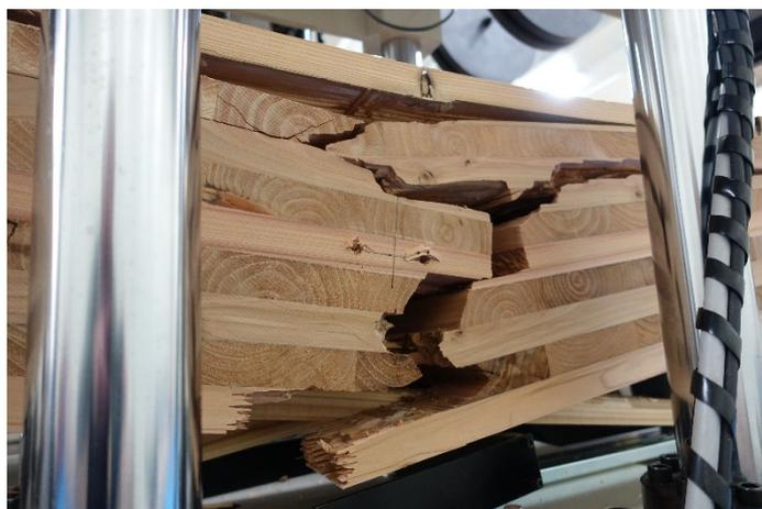
写真 7-6 DOL-92-2 引張側フィンガージョイント部破断②
