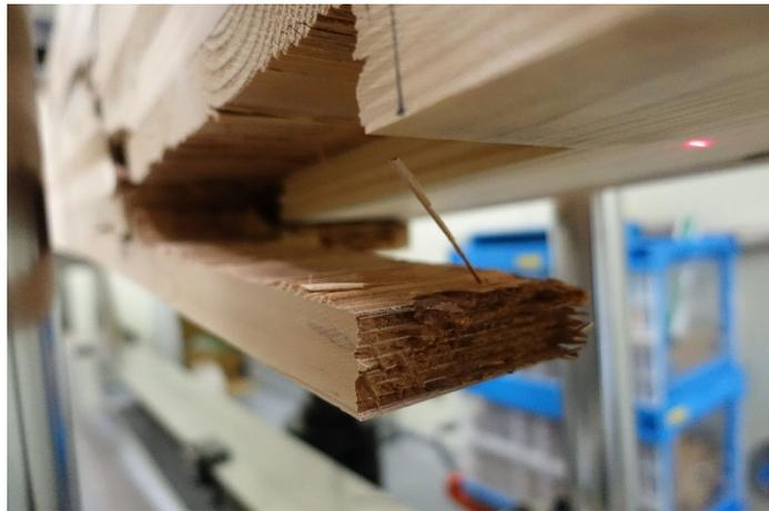
写真 7-2 DOL-94-2 引張側フィンガージョイント部破断①
