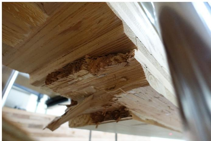
写真 7-12 DOL-88-2 引張側フィンガージョイント部破断
