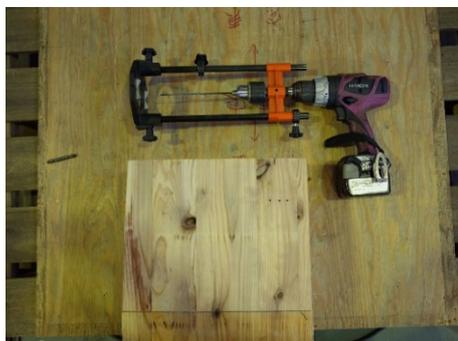
図 3-4-3 先孔切削用ドリルとドリルガイド（孔深の設定が可能）
