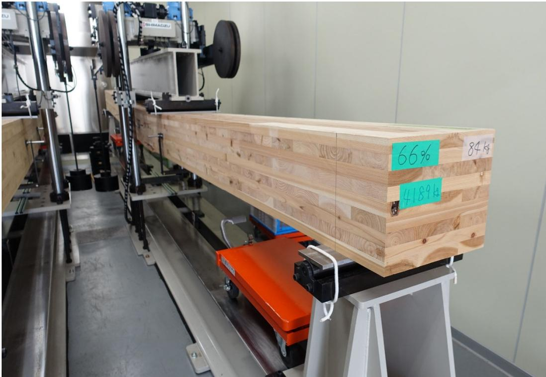
写真 4-3-1 DOL-66-1 破壊全体状況
