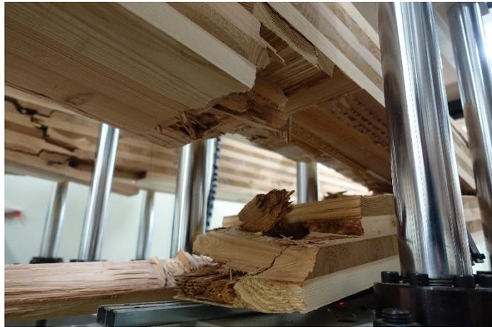
写真 7-11 DOL-88-2 破壊状況②
