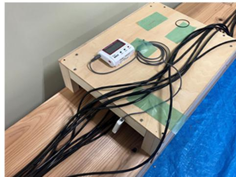
図3-4-10 温湿度の測定状況(T&D:TR-72wf)
