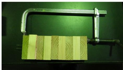
図 3-5-3 9 層 CLT を模した試験状況
