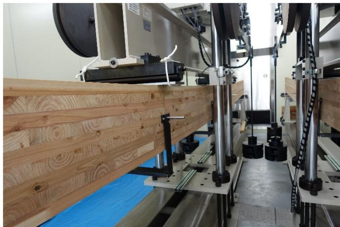
写真 7-24 DOL-70-1 破壊に至らず
