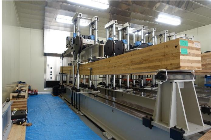
写真 7-22 DOL-70-1 全体状況 (破壊に至らず)
