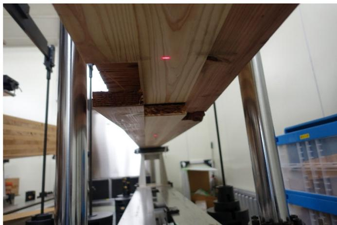
写真 7-3 DOL-94-2 引張側フィンガージョイント部破断②
