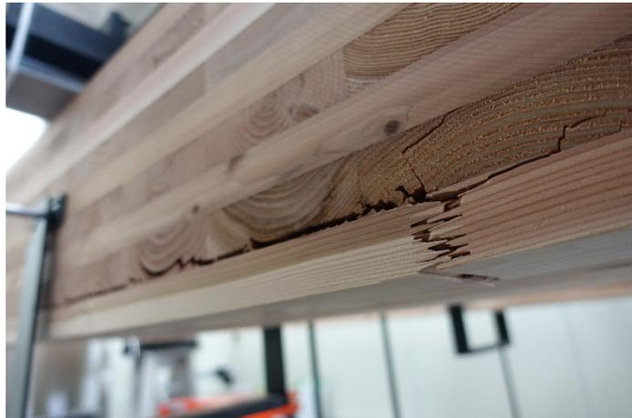
写真 7-20 DOL-72-1 フィンガージョイント部破断
