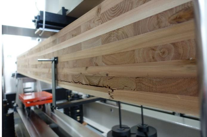
写真 7-19 DOL-72-1 破壊状況
