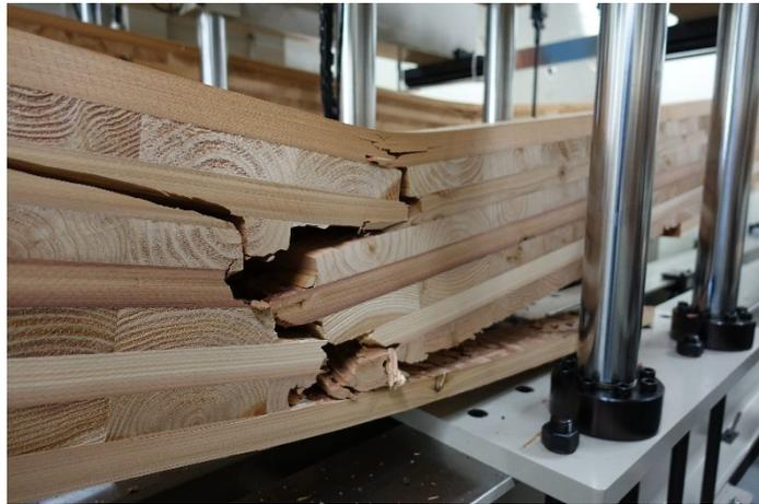
写真 7-8 DOL-90-2 破壊状況②
