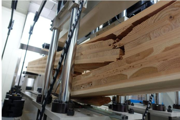
写真 7-10 DOL-88-2 破壊状況①
