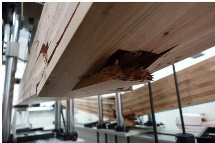
写真 7-15 DOL-86-2 引張側フィンガージョイント部破断
