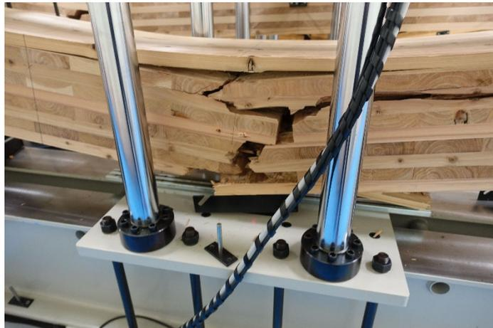
写真 7-4 DOL-92-2 破壊状況
