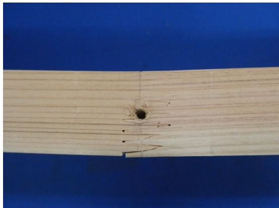
図 2-2-2 ヒノキ M120B の曲げ試験の様子と破壊形態
