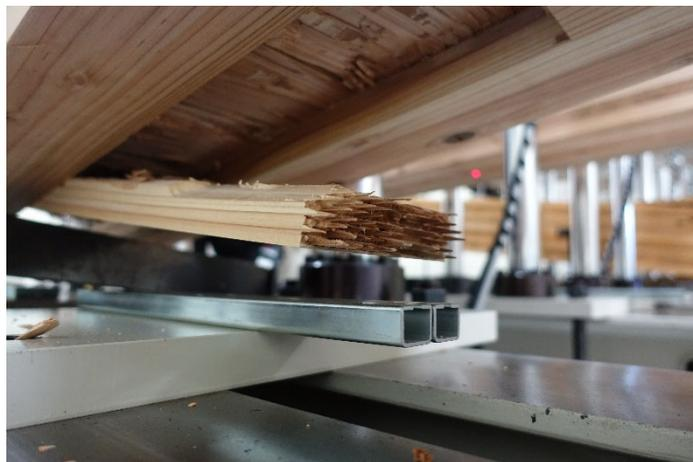
写真 7-5 DOL-92-2 引張側フィンガージョイント部破断①
