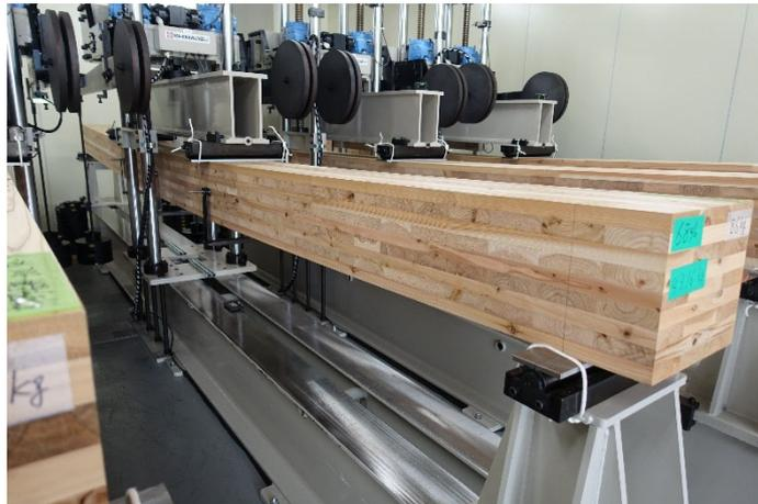
写真 7-25 DOL-68-1 全体状況（破壊に至らず）
