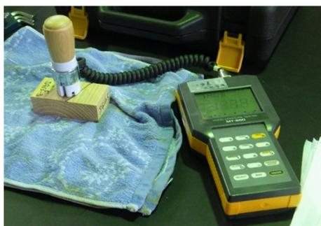
図 3-5-2 各ブロックの含水率測定
