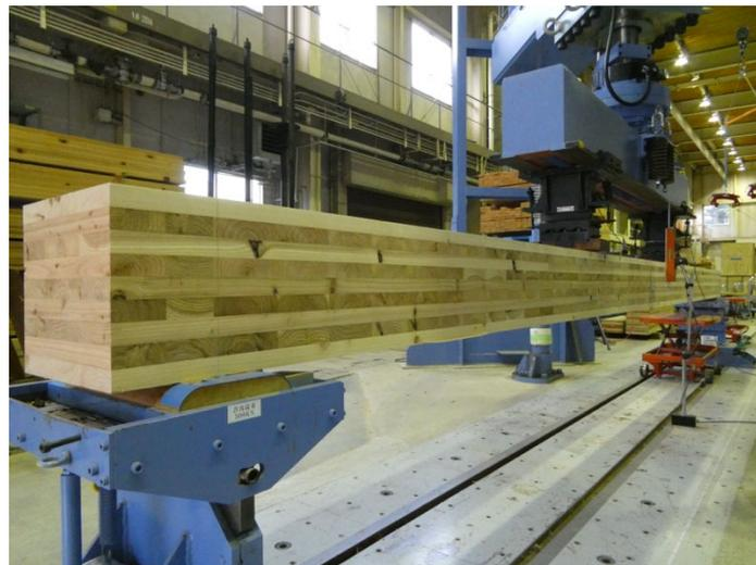
図 2-2-6 9 層 9 プライの曲げ試験の様子
