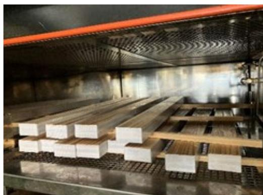
図 3-9-2 防水テープを貼り調湿中の CLT と集成材
