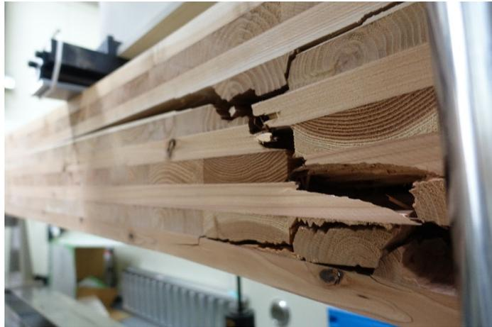
写真 7-1 DOL-94-2 破壊状況
