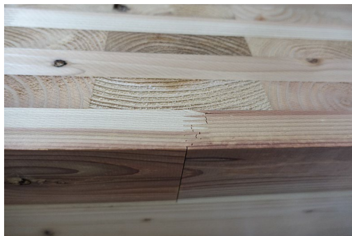
写真 7-2-12 DOL-68-2 引張側フィンガージョイント部破断②
