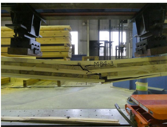
図 2-2-14 MB3 5L5P Mx60B の破壊の様子
