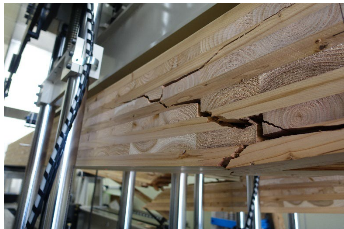
写真 7-2-13 DOL-66-2 破壊状況①
