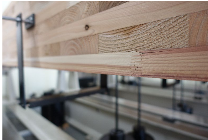
写真 7-2-11 DOL-68-2 引張側フィンガージョイント部破断①
