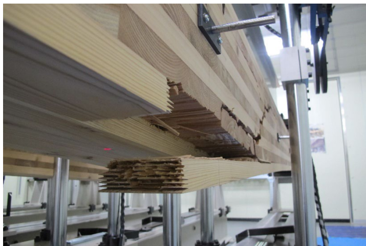
写真 7-2-21 DOL-90-3 引張側フィンガージョイント部破断
