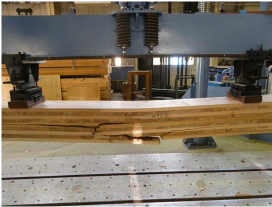
図 2-2-12 MB2 9L9P Mx60B の破壊の様子
