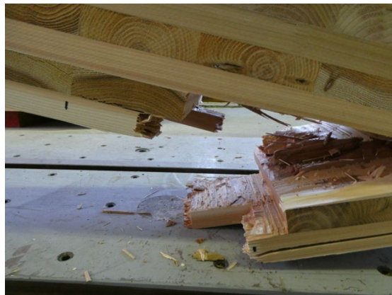
写真 4-2-3~4 破壊形態の例 (Mx60-9-9_2)
