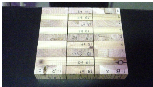
図 3-2-26 含水率測定用試験片の採取例
