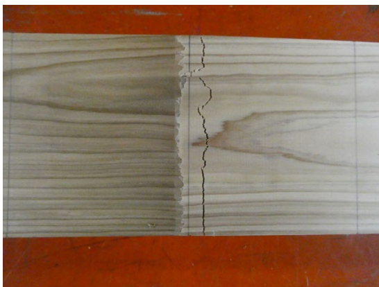
図 2-2-3 M30A の破壊形態の例
