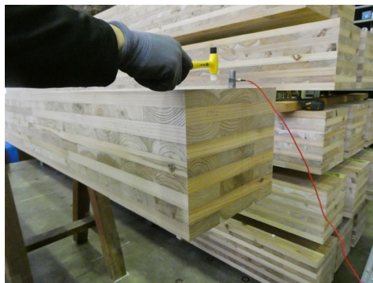
図 2-2-8 TGH 法の周波数測定の様子
