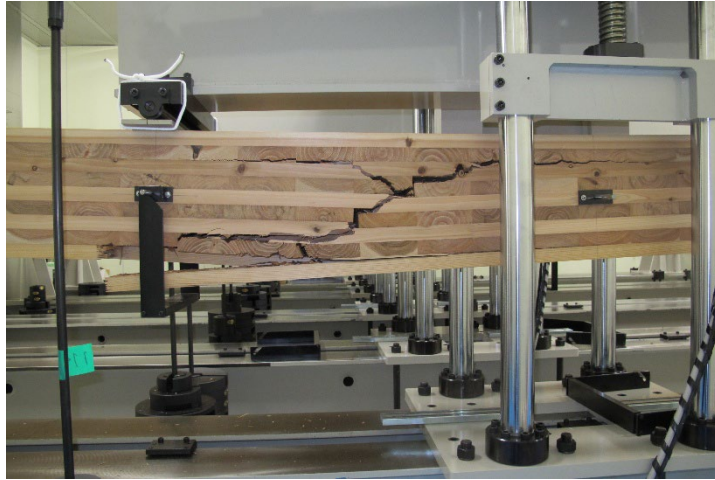
写真 7-2-19 DOL-90-3 破壊状況①
