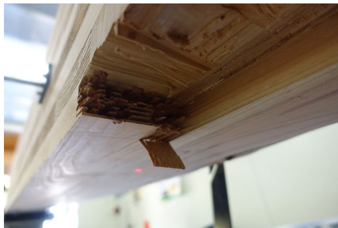
写真 7-2-3 DOL-74-2 引張側フィンガージョイント部破断②
