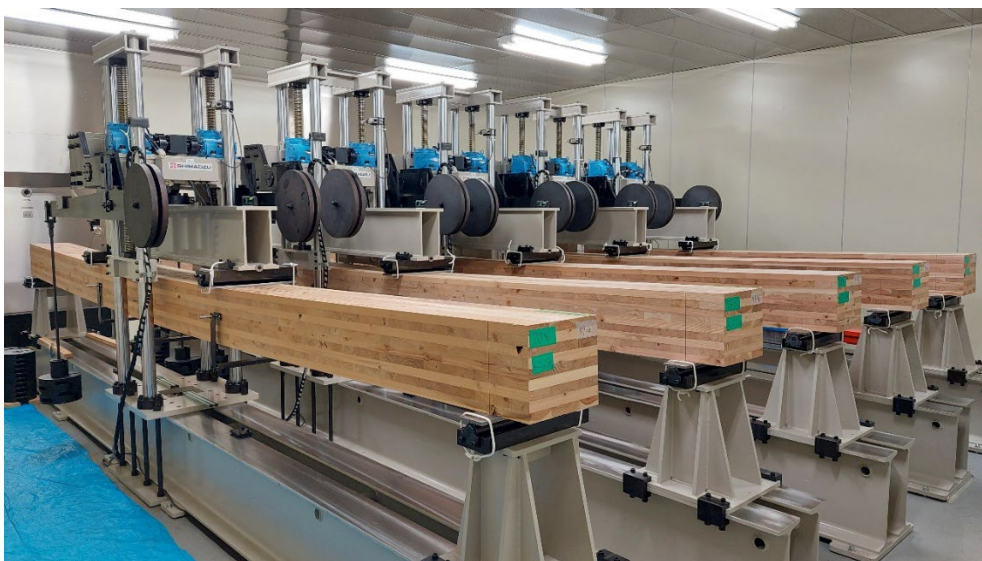
図 4-3-1 曲げクリープ破壊試験の様子
