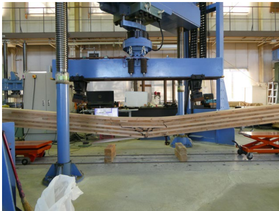
写真 4-2-5~6 破壊形態の例 (Mx60-9-9_7)
