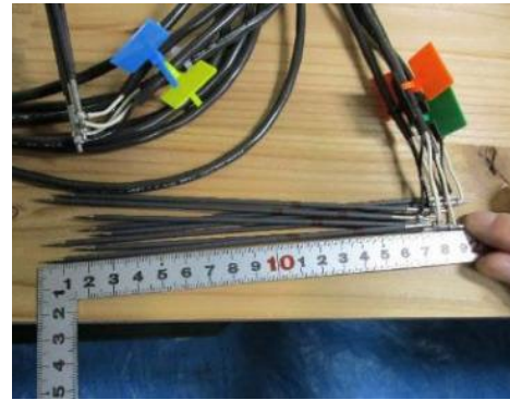
図 3-2-2 測定プローブへのリード線の接続
