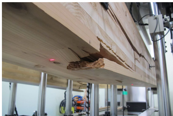
写真 7-2-18 DOL-94-3 引張側フィンガージョイント部破断
