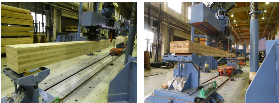
図 2-2-10 CLT の曲げ試験の様子（左：9層9プライ、右：5層5プライ）
