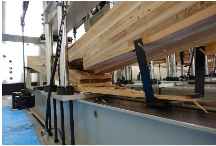
写真 7-2-1 DOL-74-2 破壊状況
