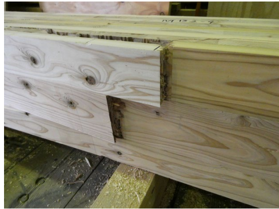
図 2-2-12 MB2 9L9P Mx60B の破壊の様子
