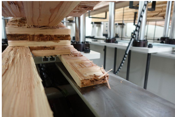
写真 7-2-2 DOL-74-2 引張側フィンガージョイント部破断①
