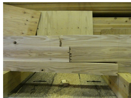
図 2-2-14 MB3 5L5P Mx60B の破壊の様子
