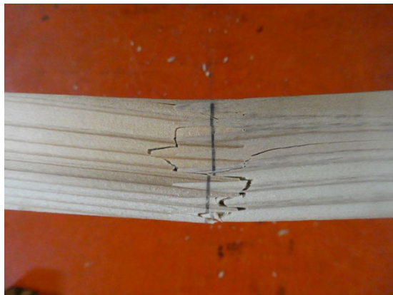
図 2-2-2 M60A の破壊形態の例
