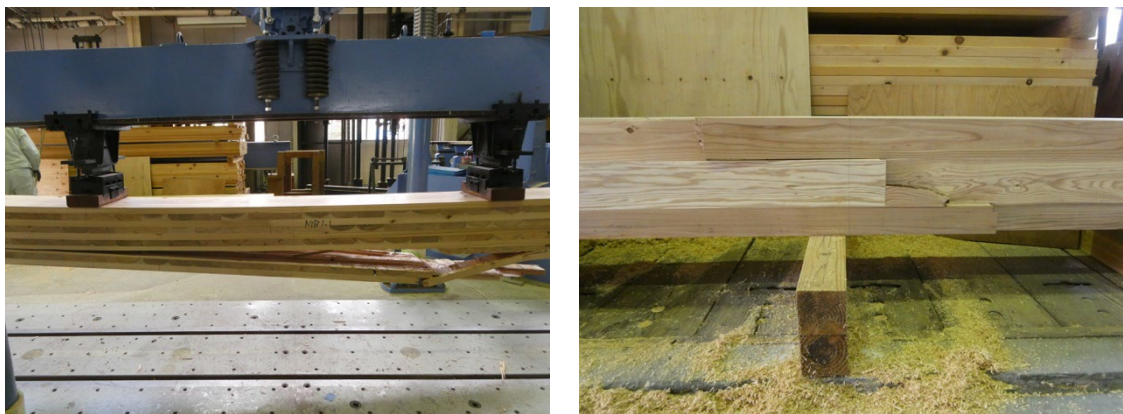
図 2-2-11 MB1 9L9P Mx60A の破壊の様子
