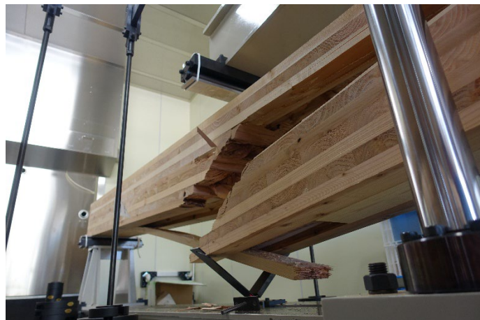
写真 7-2-4 DOL-72-2 破壊状況
