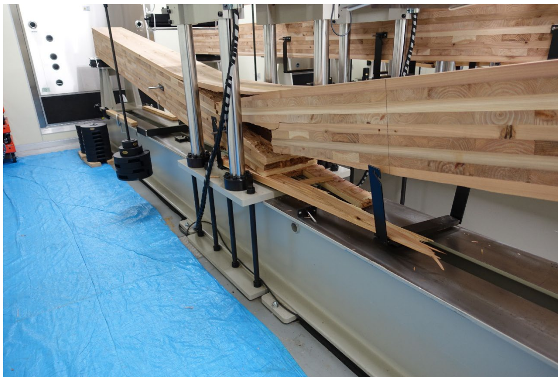
写真 4-4-2 D0L-74-2 破断状況①
