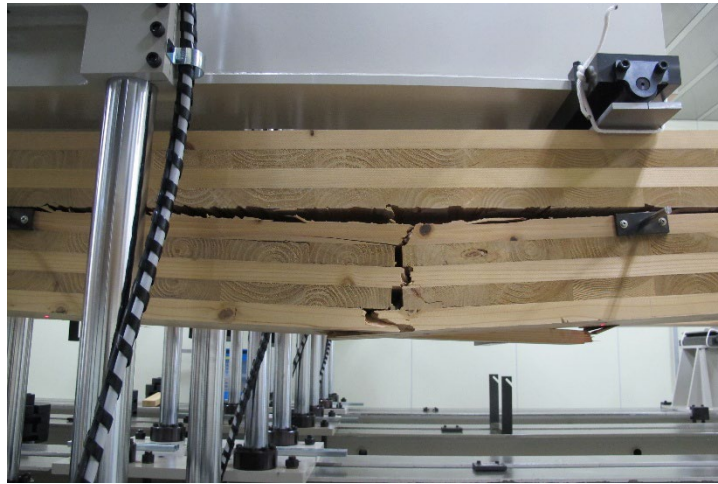
写真 7-2-16 DOL-94-3 破壊状況①
