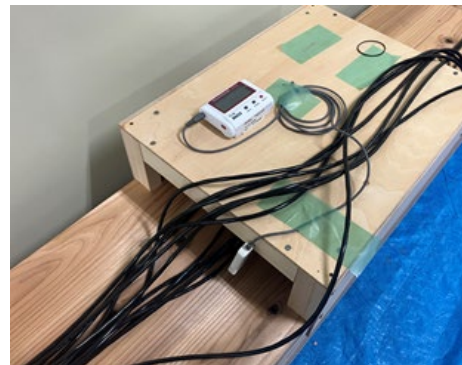
図 3-2-10 温湿度の測定状況 (T&D : TR-72wf)
