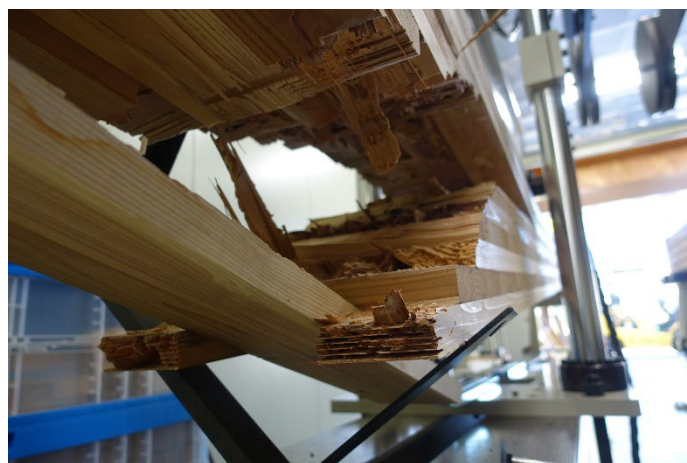
写真 7-2-5 DOL-72-2 引張側フィンガージョイント部破断①
