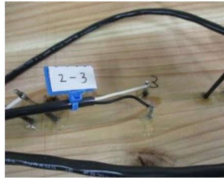
図 3-2-6 プローブの固定状況 (エポキシ接着剤充填)
