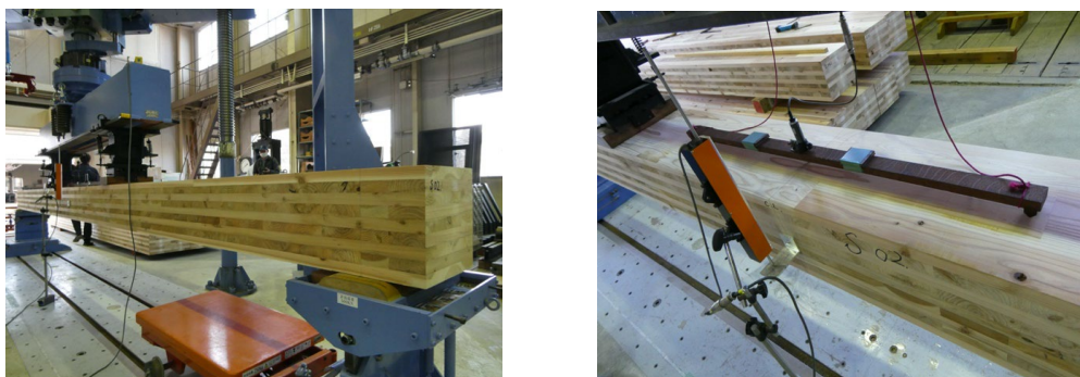
写真 4-2-1~2 CLT の短期曲げ試験の様子
