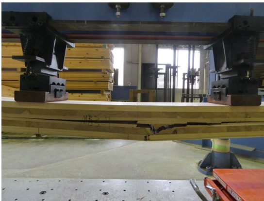
図 2-2-13 MB3 5L5P Mx60A の破壊の様子
