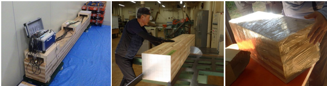
図3-2-30 含水率試験体の解体作業
