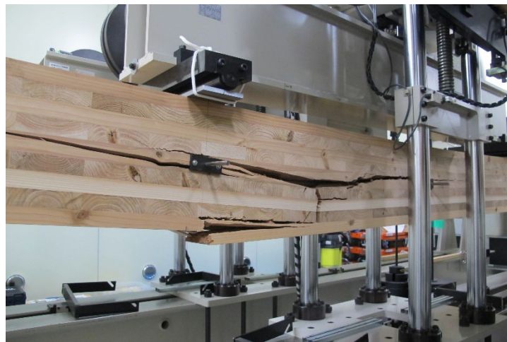
写真 7-2-17 DOL-94-3 破壊状況②
