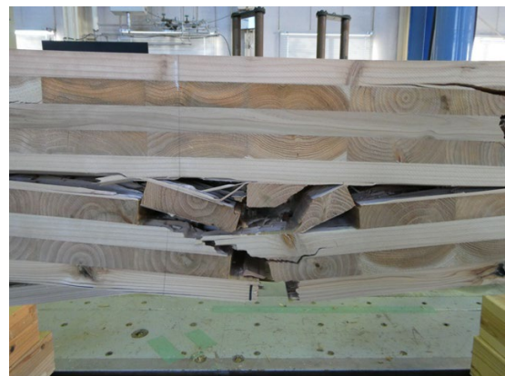
写真 4-2-5~6 破壊形態の例 (Mx60-9-9_7)
