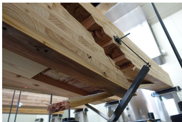
写真 7-2-6 DOL-72-2 引張側フィンガージョイント部破断②
