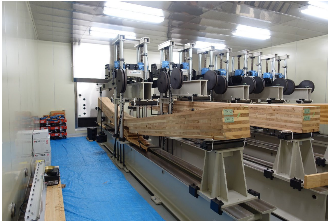
写真 4-4-1 D0L-74-2 破壊全体状況
