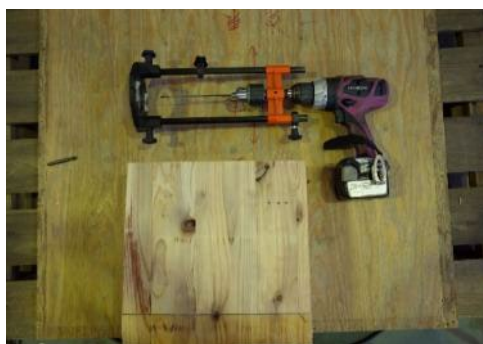
図 3-2-3 先孔切削用ドリルとドリルガイド（孔深の設定が可能）
