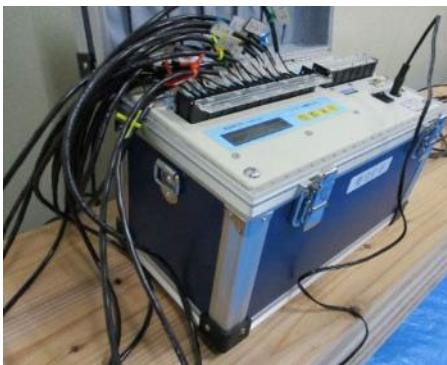
図 3-2-9 使用した含水率記録計 (コーナー札幌 : KNS-LOG)
