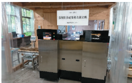
写真1 原木用非破壊検査装置
