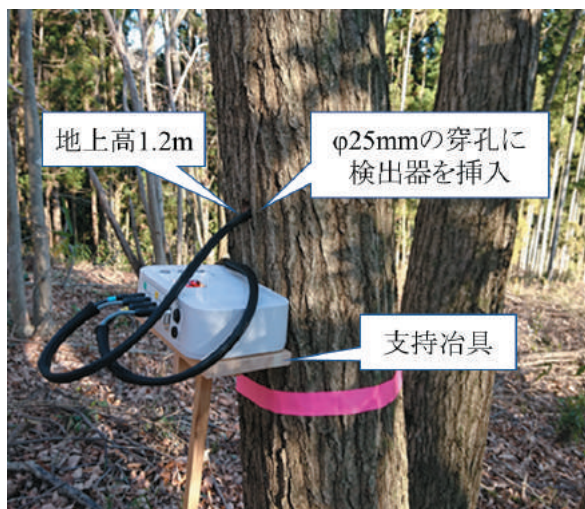
図1 可搬型検査装置による検査概要
