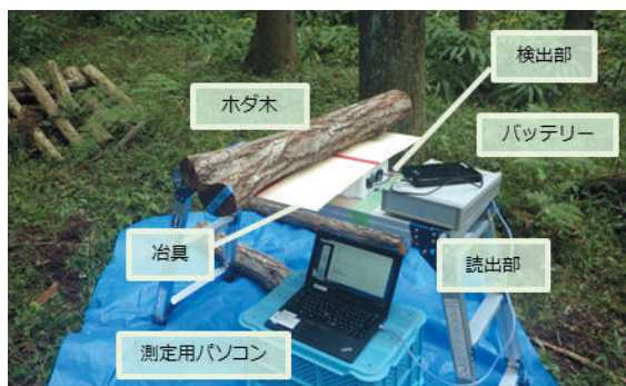
図1 可搬型検査装置による検査概要
