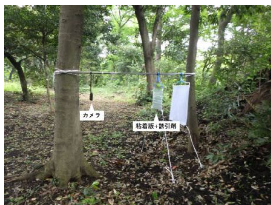
写真2 定点カメラと粘着板を組み合わせた定期的な回収を必要としない新しいトラップ 粘着版を定期的に撮影して、カシノナガキクイムシが貼り付いた日を写真から特定する。
