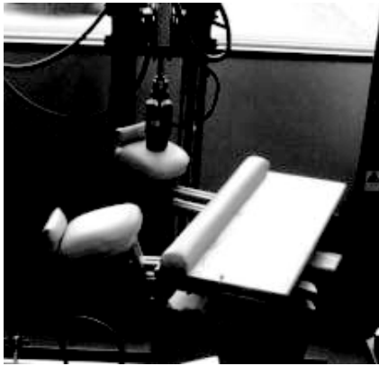
写真 2-2-5 ひじ部への垂直力試験
