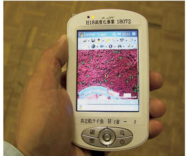
図-4. 林内誘導ナビゲーションシステム（試作機）。液晶画面には調査対象マツ林の赤外カラー写真が表示され、枯損木位置が緑でマークされている。画面中央の▲印は内蔵GPSで取得された現在位置を示す。
