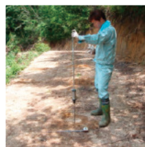
図2 簡易な貫入試験器で盛土の強さを判定する技術 鳥取県では簡易な貫入試験器で軟弱な盛土をチェックするための技術を開発しました。
