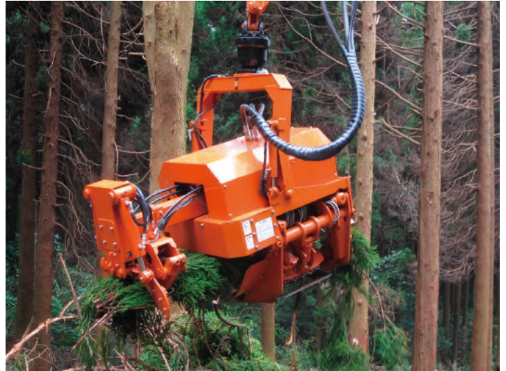
図 1 梢端部の破碎作業中のプロセッサ
