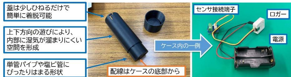
図1 計測デバイスの概要
