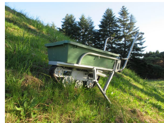
図1 アウトリガを搭載した電動クローラ型1輪車
